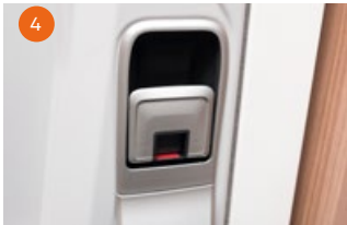
Verrouillage interne avec indicateur.
