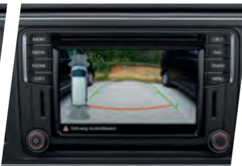
**Caméra de recul « Rear View ».** La caméra de recul « Rear View » facilite les manœuvres de stationnement en représentant la zone située à l'arrière du véhicule sur l'écran<sup>2)</sup> ou du système de navigation. Des lignes de guidage fixes montrent comment s'orienter lors de la manœuvre. | BE | CO | OC |
