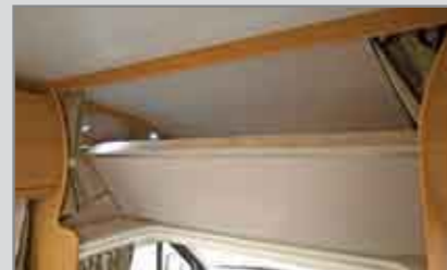
Hubbett Das Alkovenbett kann angehoben werden, um den Zugang ins Führerhaus zu erleichtern. Pull-down type bed The overcab bed can be raised to allow better access to the cab.
