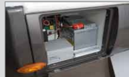
Fach der Nutzbatterie und Netzgerät mit äußerem Zugang von den Seiten. Dank dieser Unterbringung entsteht kein Lärm im Inneren und die Wartung ist einfacher. Service battery and power supply unit compartment with easy access from outside. Owing to this housing there is no noise inside and maintenance is easier.
