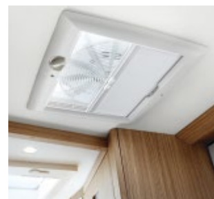
V3009011 Ventilateur au-dessus de la cuisine
