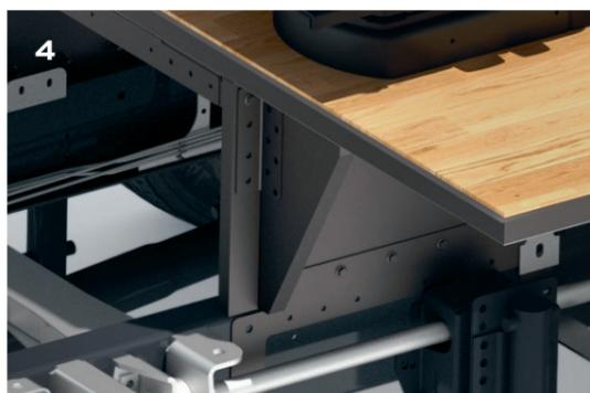
**Plancher** Pour procurer à nos liners un plancher isolé sur seul niveau, nous surélevons le poste de conduite. La structure du plancher est constituée de panneau sandwich aluminium et de profils métalliques, pour le rendre particulièrement résistant aux conséquences d'une collision.
