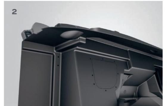
**Cloison anti-encastrement** La nouvelle conception plus rigide et stable de la cloison qui compartimente la cabine de conduite, répond aux exigences de sécurité les plus élevées. Sa construction en fibre de verre renforcée a été optimisée par une multitude de simulations informatiques.
