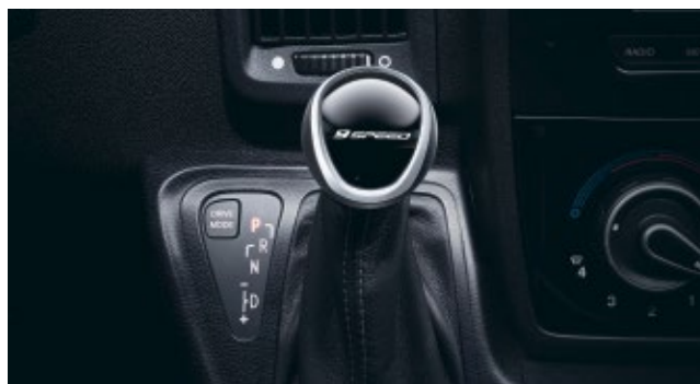
80054 Boîte de vitesses automatisée ZF AT9
