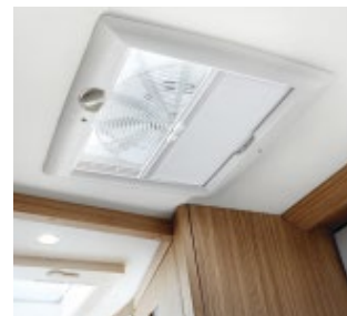
9403 Ventilateur au-dessus de la cuisine
