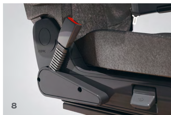
Prétensionneurs de ceinture La ceinture de sécurité doit être ajustée et les occupants interceptés le plus tôt possible en cas de choc. Les prétensionneurs de ceinture intégrés tendent la ceinture de sécurité en quelques millièmes de seconde et réduisent de ce fait, les risques de blessures.
