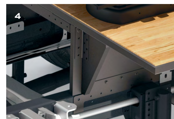
Plancher Pour procurer à nos liners un plancher isolé sur seul niveau, nous surélevons le poste de conduite. La structure du plancher est constituée de panneau sandwich aluminium et de profils métalliques, pour le rendre particulièrement résistant aux conséquences d'une collision.
