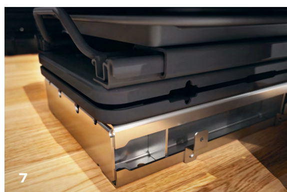
Consoles de siège 42% plus légères et pourtant plus stables. Grâce à nos nouvelles consoles de siège renforcées, de conception allégée, nous avons pu réduire la déformation de 95% en cas de crash. L'intégration de deux crochets d'arrimage par console de siège, assure une protection supplémentaire en cas de choc.
