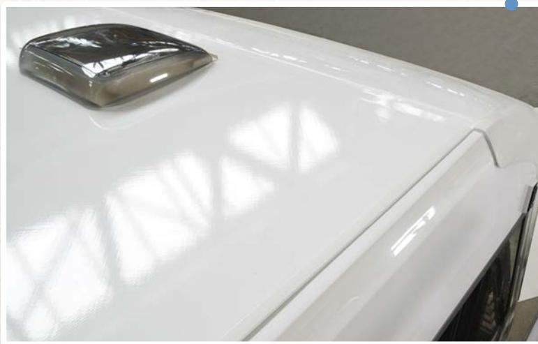
La jonction du toit avec la face avant est sans déport, afin d'éviter une accumulation d'eau, qui s'écoulerait vers l'avant.
