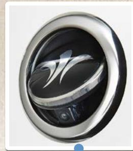
L'arrière est complété par des feux arrière à LED avec la signature de nuit triple unique et la caméra de recul est élégamment et intelligemment intégrée sous le logo, la protégeant ainsi des salissures.
