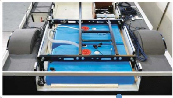
Le châssis surbaissé AL-KO à voie extra-large est modifié, de sorte que l'ensemble de la structure, ainsi que le centre de gravité soit rabais-sé. Cet effet est renforcé par de grands réservoirs d'eau dans le double plancher, pour rabaisser davantage le centre de gravité.
