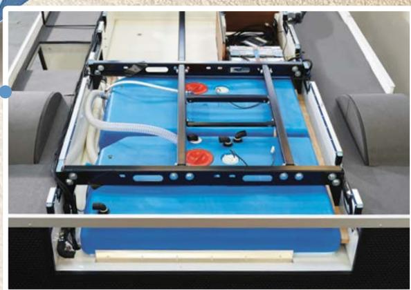
Les grands réservoirs d'eau ne peuvent pas geler à des températures en dessous de zéro, dans la mesure où ils sont situés dans le double-plancher hors-gel, isolé avec deux panneaux sandwich revêtu d'aluminium.
