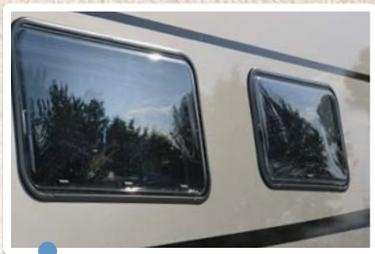
Les baies latérales en double vitrage par rapport à une baie latérale traditionnelle à simple vitrage, offrent une meilleure isolation et procurent par ailleurs 80 % de protection thermique en plus.
