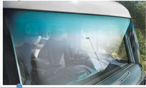
Au cas où ce bandeau serait insuffisant, vous avez également la possibilité d'occulter le pare-brise panoramique, en abaissant plus ou moins, le volet roulant frontal intégré à commande électrique.
