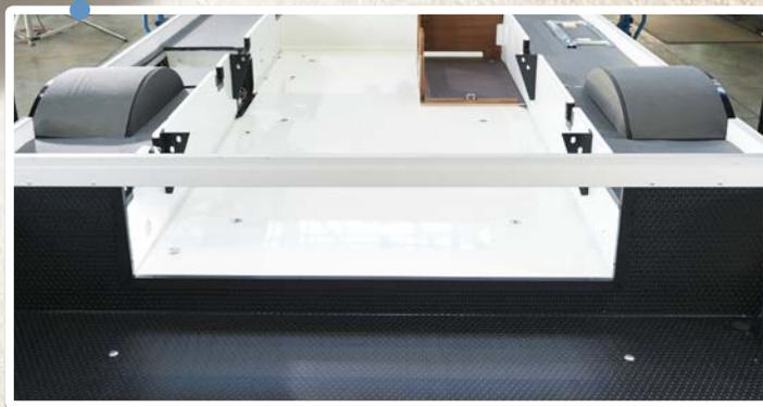
Le double-plancher isole également l'habitacle du véhicule, étant donné que le dessous de caisse complet est en panneaux d'aluminium double couche.
