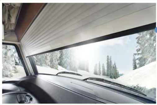
Pour le grand pare-brise panoramique, nous avons dû faire preuve d'imagination. En effet, il ne peut être pourvu d'un double vitrage. Pour que le froid reste au dehors, on a breveté la pose frontale d'un volet roulant isolant en aluminium à commande électrique. L'espace est également directement chauffé.
