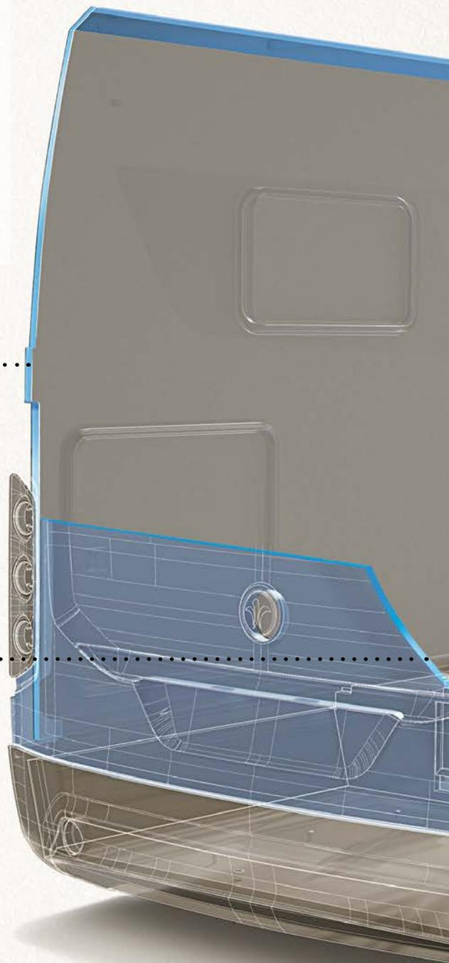
Le raccord entre le toit et la paroi latérale est exempt de pont thermique, grâce aux panneaux cintrés en aluminium double couche.
