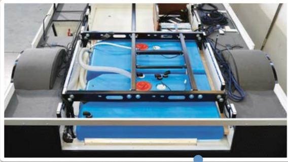
Der AL-KO Tiefrahmen mit Superbreitspur wird so modifiziert, dass der gesamte Aufbau und damit auch der Schwerpunkt des Arto tiefergelegt werden. Verstärkt wird dieser Effekt durch die großen Wassertanks in der Wanne des Doppelbodens, denn so liegt der Schwerpunkt noch ein wenig tiefer.
