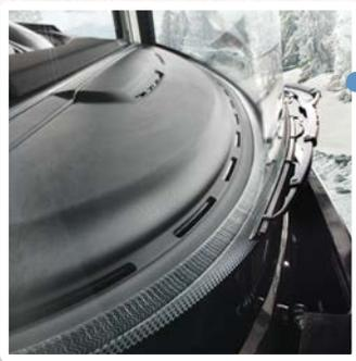
Die Hinterlüftung an der Frontscheibe wirkt zusammen mit den Heizkonvektoren wie ein Wärmevorhang.
