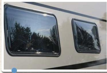
Die optionalen doppelverglasten Seitenfenster sorgen für eine bessere Isolation und bieten zudem bis zu 80% mehr Wärmeschutz als herkömmliche, einfachverglaste Seitenfenster.
