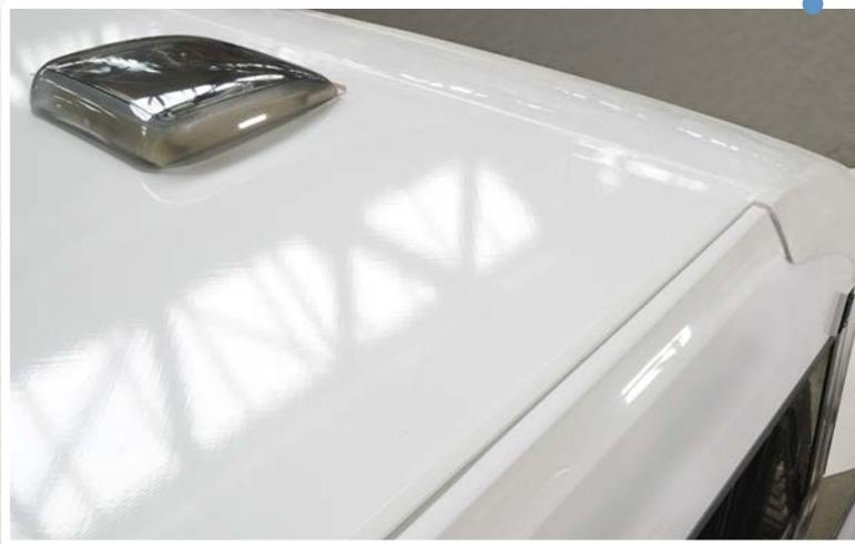
Der Übergang von der Bugmaske zum Dach ist plan verbunden, sodass ein Rückstau des Wassers vermieden wird und das Wasser nach vorne abläuft.
