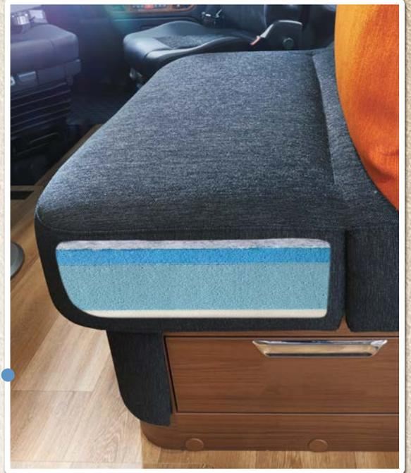
Das 3-Lagen-Schaumkonzept garantiert einen hohen Sitzkomfort auf dem Sofa. Geprüfte 50.000 Scheuertouren zeugen von einer besonderen Langlebigkeit der Bezüge. Eine Aussparung im Polster erleichtert das Öffnen der darunterliegenden Stauräume.
