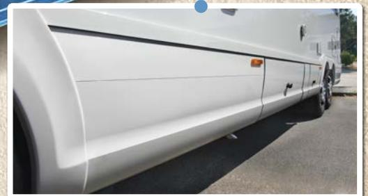
Die aufwändig geformten Seitenschürzen aus lackierten Aluminiumprofilen verleihen dem Arto ein sportliches Außendesign. Sie verdecken Chassisrahmen und die eingefahrene Außentrittstufe.
