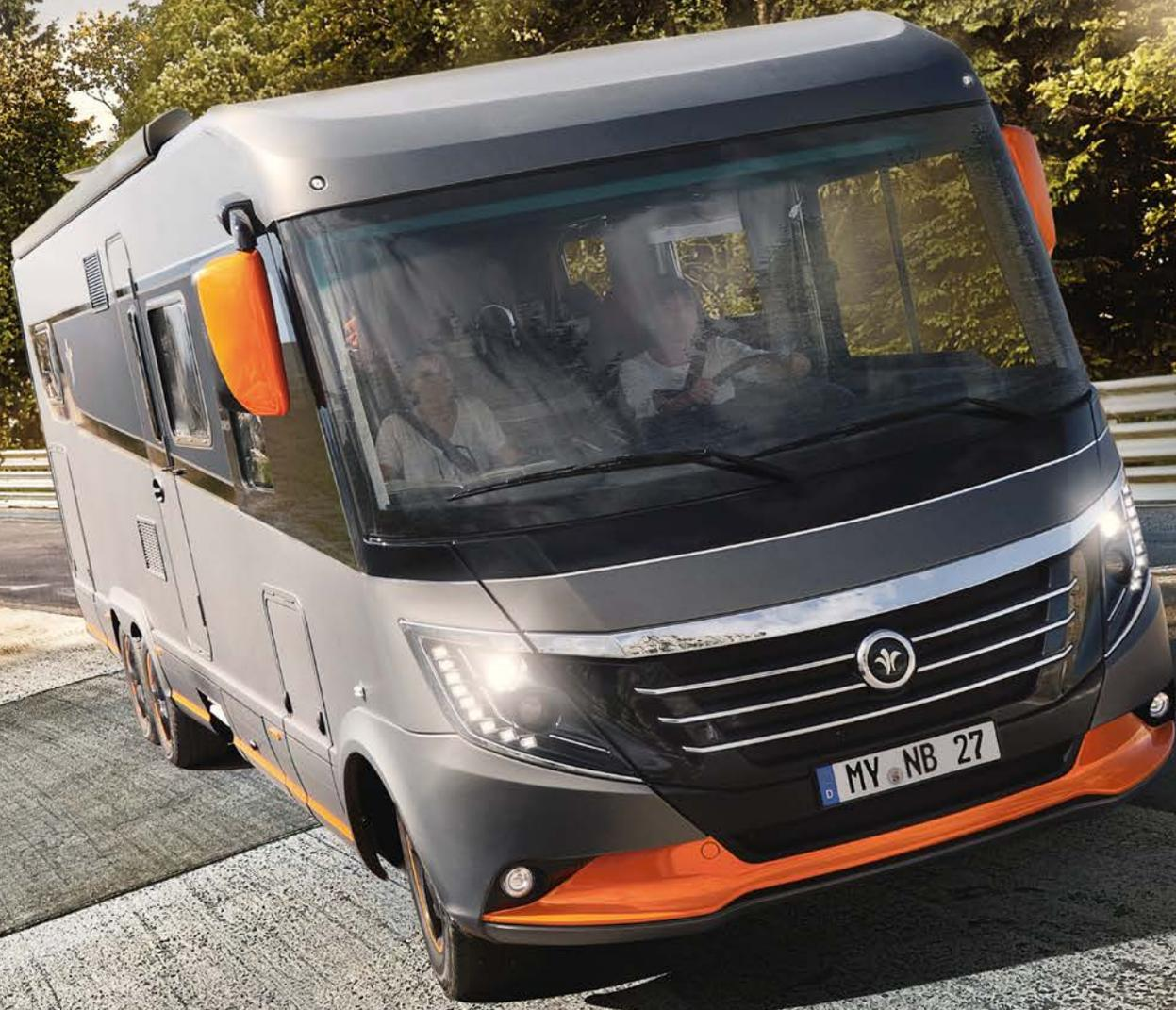
Wir haben den Arto auf eine ganz besondere Teststrecke geschickt. Hier wurde er besonders starken Rüttelbelastungen ausgesetzt, sodass schon nach 100 Runden eine Beanspruchung stattgefunden hat, die etwa 100.000 gefahrenen Kilometern entspricht. Auf diese Weise finden wir selbst kleinste Schwachstellen sofort und können sie schnell beheben.
