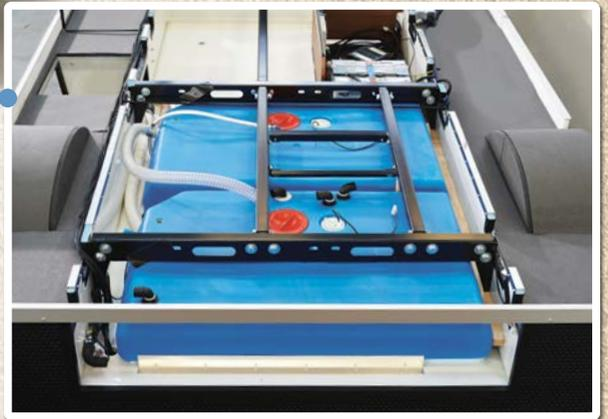
Die großen Wassertanks können auch bei Minustemperaturen nicht einfrieren, denn sie liegen in der frostsicheren Bodenwanne, isoliert mit 2-sided-Aluminium-Sandwich.
