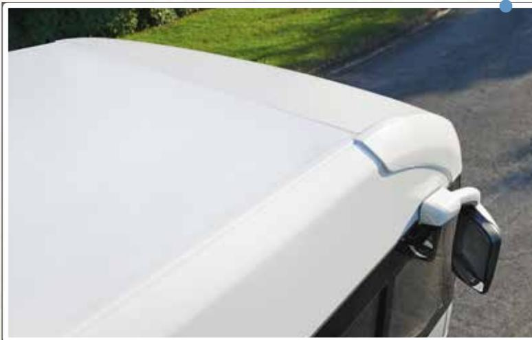
La jonction du toit avec la face avant est réalisée sans rebord, afin d'éviter toute accumulation d'eau qui s'écoulerait vers l'avant.
