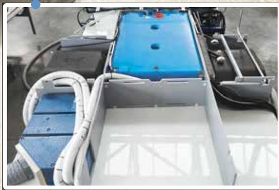
Le dessous de caisse étant recouvert d'aluminium double couche, le double plancher fait office de réservoir de chaleur et permet d'isoler efficacement l'intérieur du Flair.
