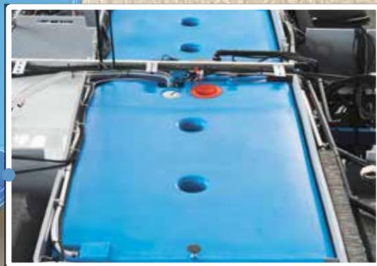
Les grands réservoirs à eau ne craignent pas le gel, même par des températures négatives, car ils sont situés dans le double-plancher chauffé et isolé par des panneaux revêtus d'aluminium double-face. La porte de la soute arrière permet un accès facile pour les sortir et les échanger.
