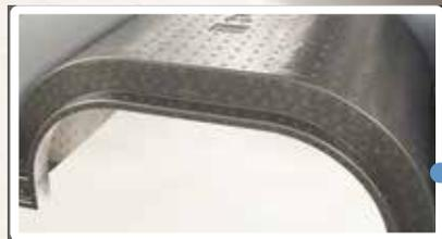
L'isolation des passages de roues arrière au moyen de polypropylène expansé s'avère très efficace pour réduire le niveau sonore et le froid à l'intérieur du véhicule.
