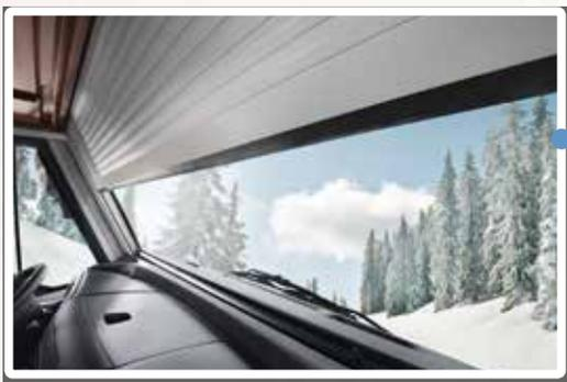
Pour le grand pare-brise panoramique, nous avons dû faire preuve d'imagination. En effet, il n'existe pas en version double vitrage. Qu'à cela ne tienne, pour que le froid reste au dehors, on a breveté la pose frontale d'un volet roulant isolant en aluminium à commande électrique. L'espace entre le store et le pare-brise est de plus directement chauffé.
