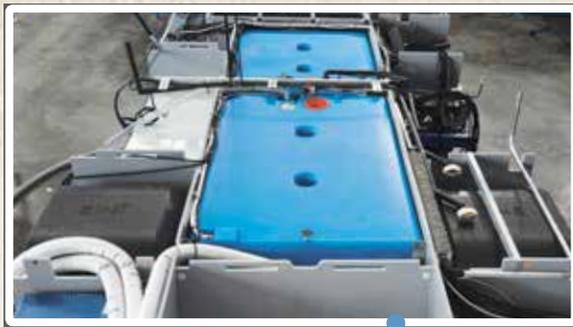
Nous avons veillé à ce que la répartition des charges soit optimisée. Par exemple, les réservoirs d'eau propre ont été positionnés sur l'essieu arrière pour assurer une parfaite tenue de route.
