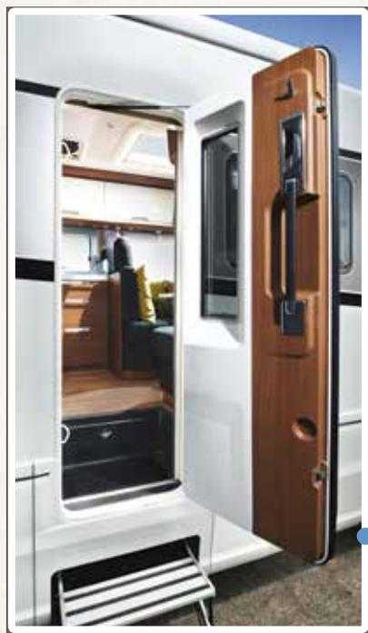
La porte d'accès et la soute arrière dispose d'un verrouillage à deux points avec assistance électrique de fermeture.
