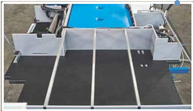
Le double-plancher associé au châssis permet d'accroître la rigidité du véhicule et ainsi d'assurer un grand confort de conduite. De plus, cette conception permet également d'accroître l'isolation thermique et phonique du véhicule.
