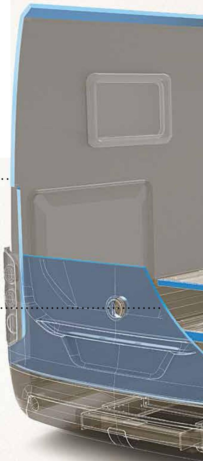
La jonction entre le toit et les parois latérales est également exempte de pont thermique, grâce aux panneaux cintrés en aluminium double couche.
