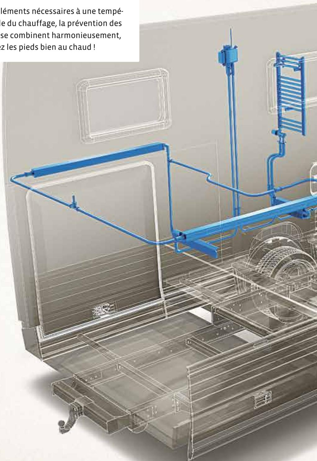
Grâce à l'espace préservé derrière les placards de pavillon et les banquettes, l'air peut circuler de manière optimale et diffuser la chaleur dans toute la pièce.
