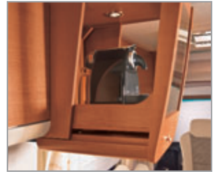
Cette petite armoire vitrée compacte est escamotable. Une fois extraite du pavillon, elle est accessible par les côtés.
