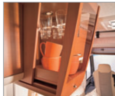
Cette petite armoire vitrée compacte est escamotable. Une fois extraite du pavillon, elle est accessible par les côtés.
