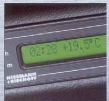
Elektronische Zeit- und Außen-Temperaturanzeige im Cockpit des integrierten Flair.
