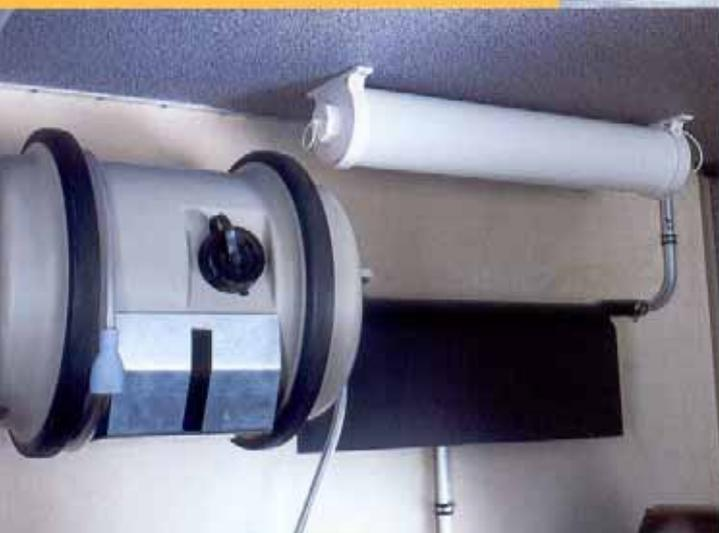
*Der mobile Frischwassertank mit Halter in der Flair-Garage passt an die Tauchpumpe des Versorgungsmoduls und fasst 40 Liter (Sonderausstattung).*
