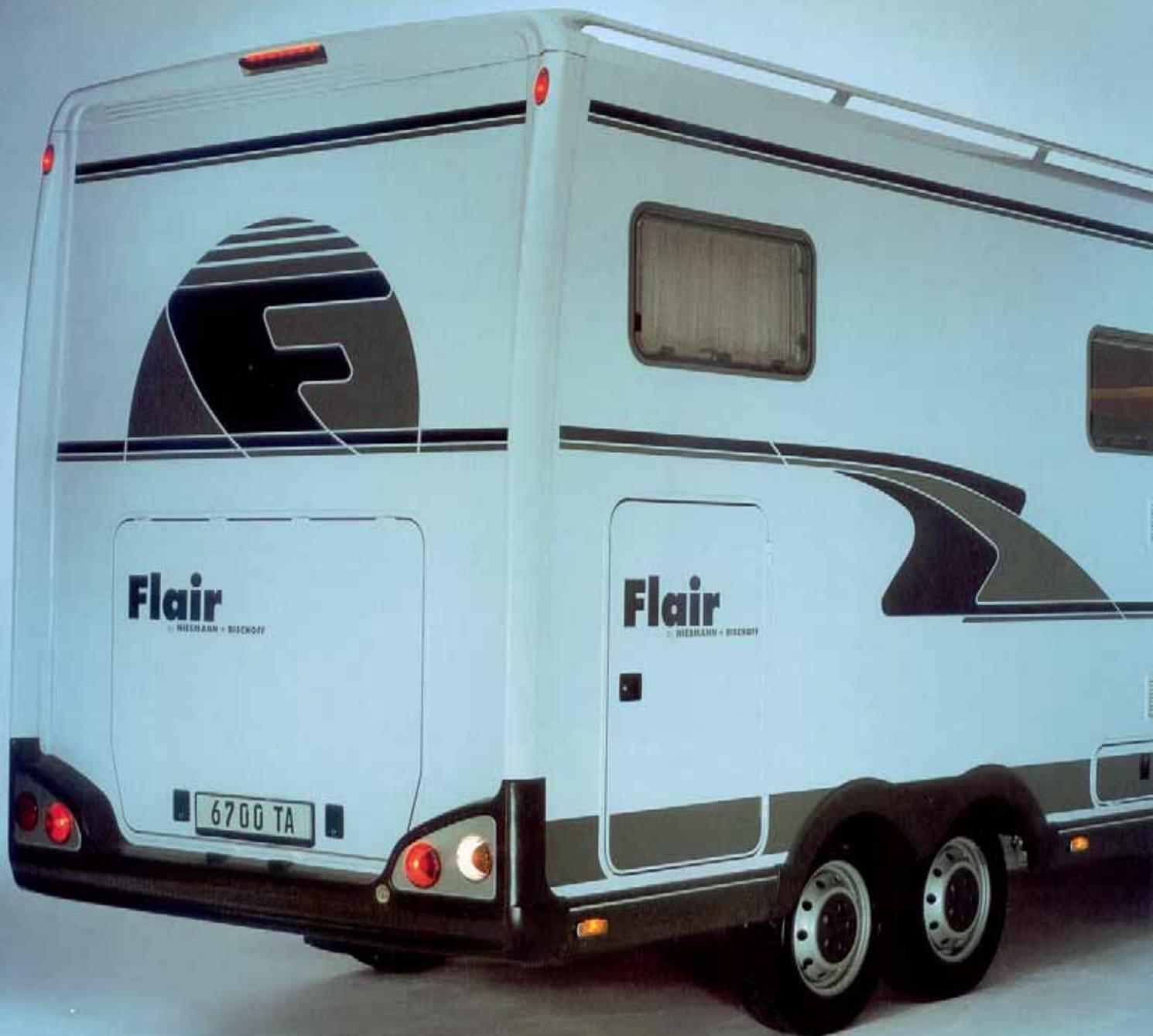
Der Flair-Aufbau aus 40 mm starken Alu-Hartschaum-Alu-Sandwichplatten und intelligent konstruierter Verbindungstechnik garantiert höchste Sicherheit und Stabilität.
