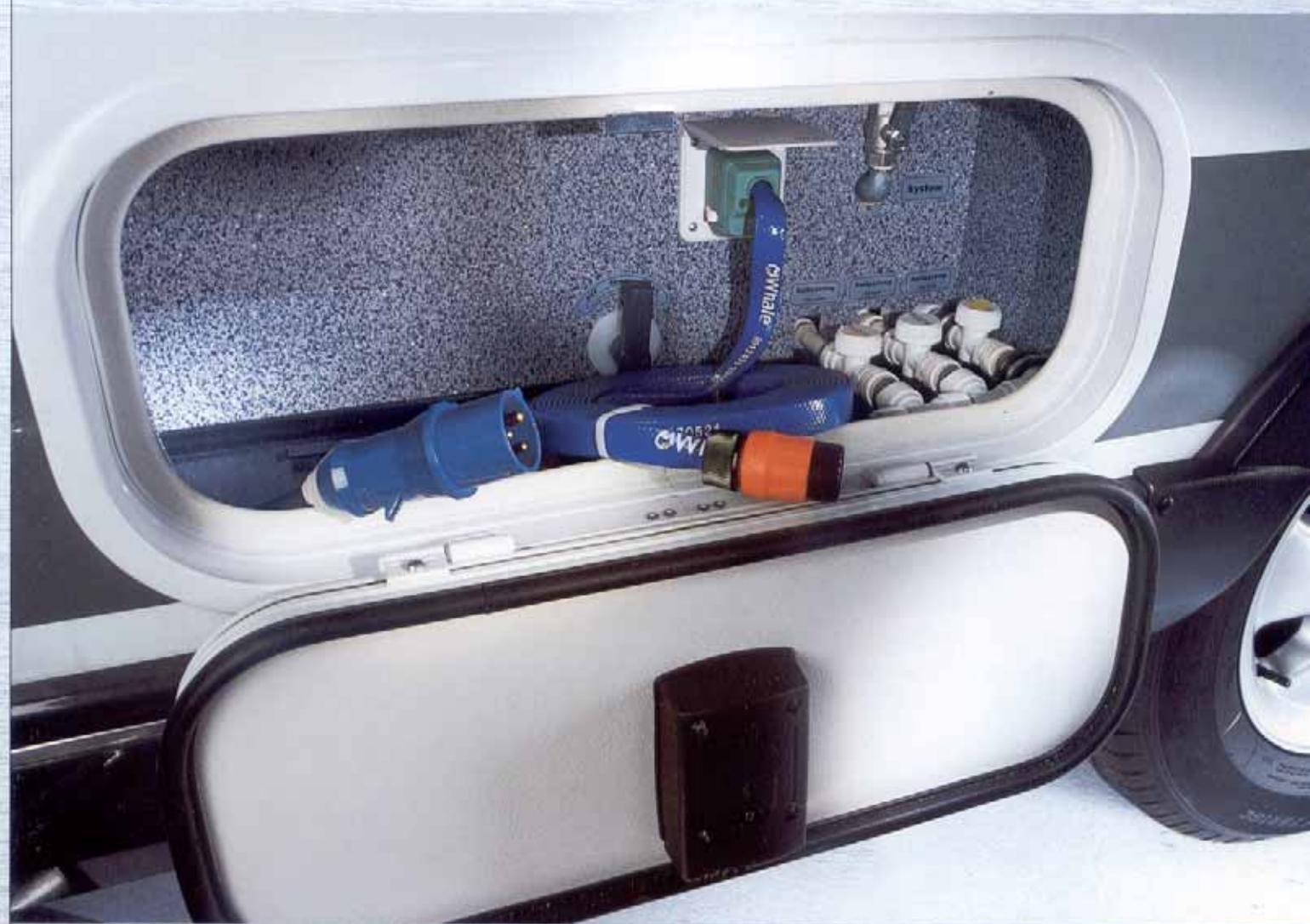
Die Serviceklappe an der linken Außenseite mit Stromanschluss und Stadtwasseranschluss (Sonderausstattung). Außerdem sind hier alle Ventile für Abwassertank, Frischwassertank, Warmwasser- und Kaltwassersystem untergebracht.
