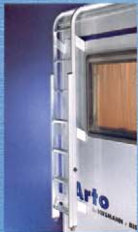
Die optionale Heckleiter aus formstabiler Aluminiumlegierung.
