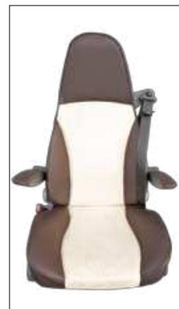
Sièges chauffeur et passagers FASP avec ceinture intégrée
