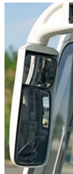
Electric rear-view mirrors with wide-angle view. / Neue Rückfahrspiegel mit breitem Sehwinkel und Enteisung.
