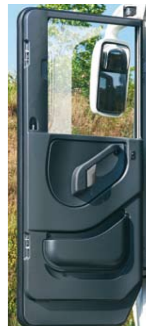
Luxury Dometic driver's door with two point locking, double glazed window, integrated blind and central locking system. / Dometic Luxusfahrertür mit 2-Punkten Abriegelungen, Doppelverglasung, integrierter Abdunklung und Zentralverriegelungssystem.
