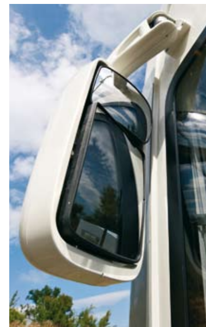
New rear-view mirrors in bus type with wide angle view, and power defrost with electrical adjustment on RX Platinum. / Neue elektrische Rückfahrspiegel wie bei einem Bus mit weitem Blickwinkel und Enteisung auf dem RX Platinum.
