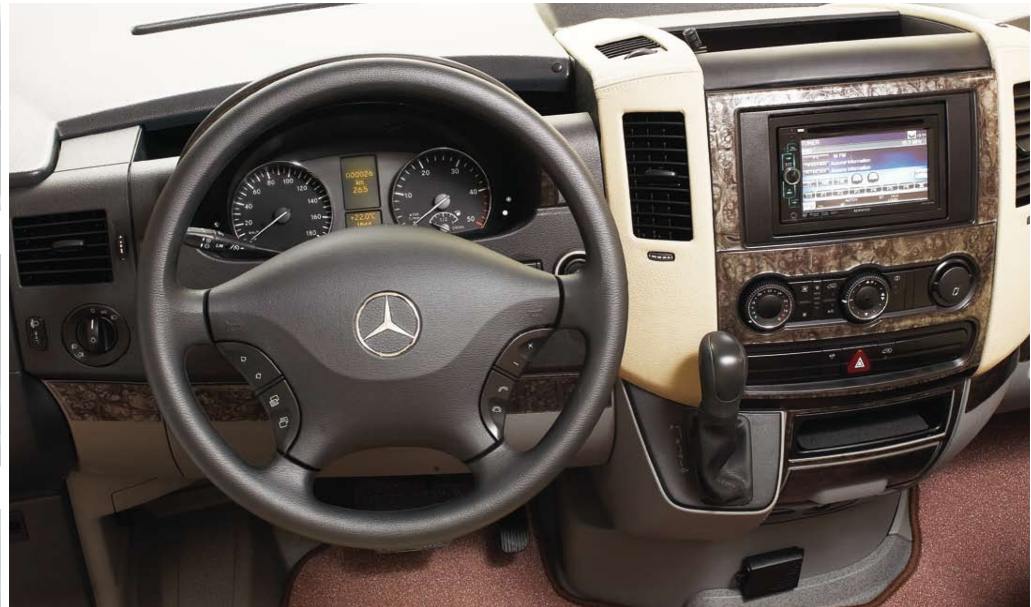
On-board computer, Radio CD and DVD with video playback in the TV cabinet. The screen of the radio integrates the reversing camera view and the playing of the DVD player. Multifunction adjustable steering wheel. / Die Fahrerkabine ist mit einem Bordcomputer, Autoradio CD und DVD und Multifunktionslenkrad ausgestattet. Die Rückfahrkamera mit integriertem Bildschirm besteht aus einem System, das es ermöglicht, eine DVD über den Fernseher einzulesen.
