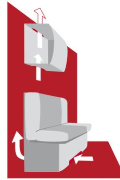
TOP – concept de circulation d'air grâce au système de circulation d'air derrière les meubles et le double plancher
