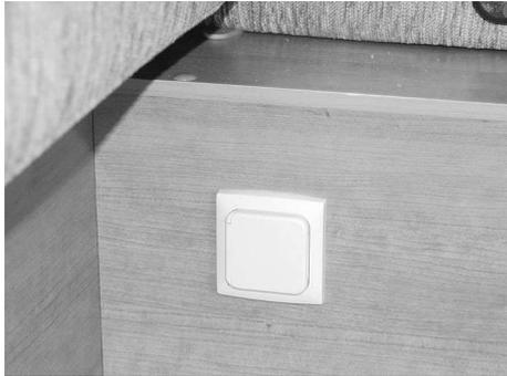
Les prises de courant pour l'emploi de petits appareils électriques lorsque l'alimentation externe est branchée, se trouvent - suivant le modèle et l'équipement - aux endroits stratégiques du véhicule (par exemple au niveau des pieds près de la banquette).
