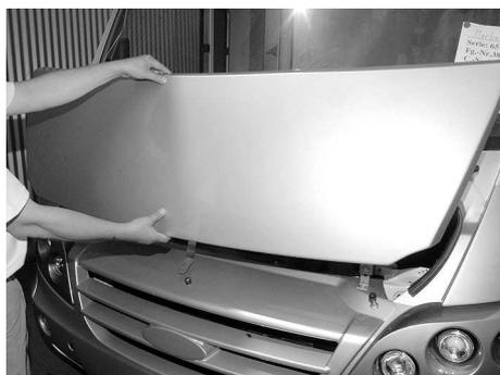
Fig. 93 : Soulever le capot moteur
