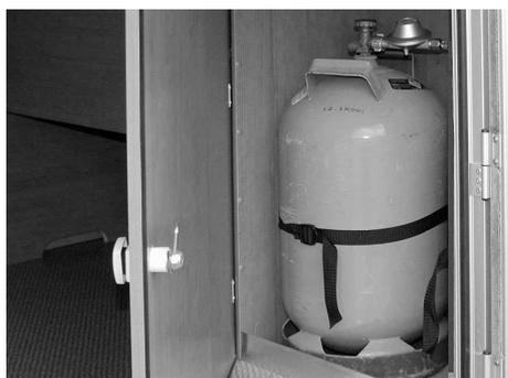
Fig. 106 : Casier à bouteille de gaz
