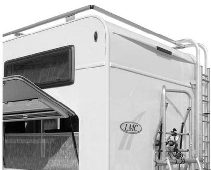
Fig. 80 : Galerie de toit et échelle arrière
