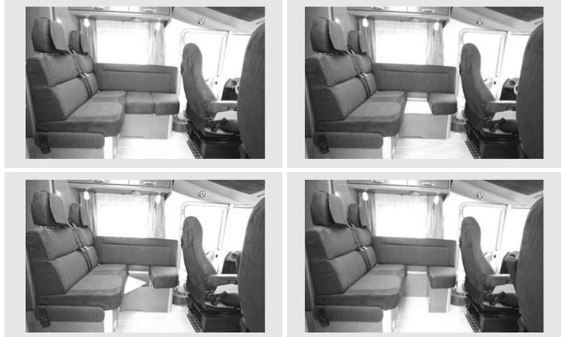
Fig. 95 : Transformation de la banquette en L en une rangée de sièges pour les passagers
