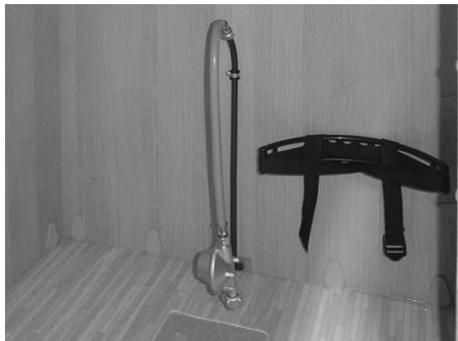
Fig. 52 : Casier à bouteille de gaz : exemple de disposition de principe dans le garage arrière
