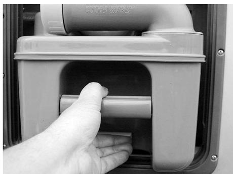
Fig. 133 : Réservoir de matières fécales dans le puits d'élimination du WC
