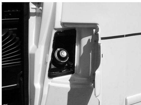
Fig. 8 : Orifice de remplissage de carburant
