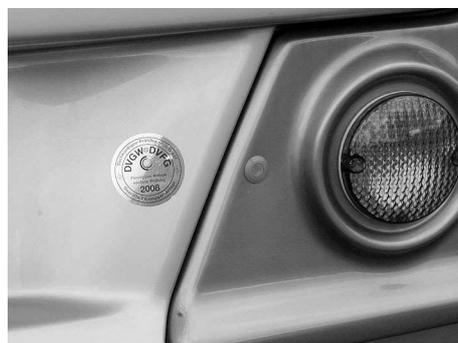
Fig. 4 : Plaque d'homologation de l'installation à gaz
