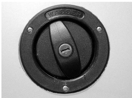
Fig. 71 : Manchon de remplissage d'eau propre
