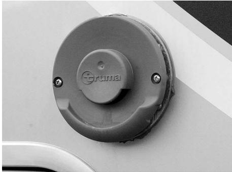
Fig. 61 : Conduit d'évacuation
