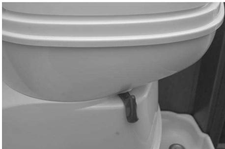
Fig. 132 : Volet sur la cuvette des WC
