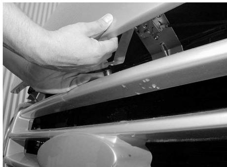
Fig. 92 : Déverrouillage du capot moteur
