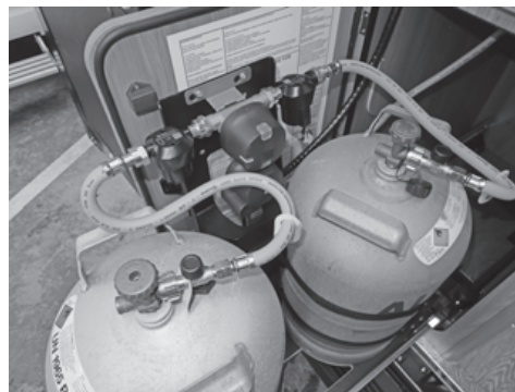
Tiroir du compartiment de bouteilles de gaz DuoControl CS
