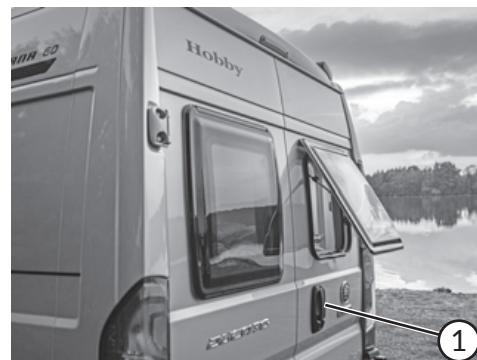
Porte arrière extérieure
