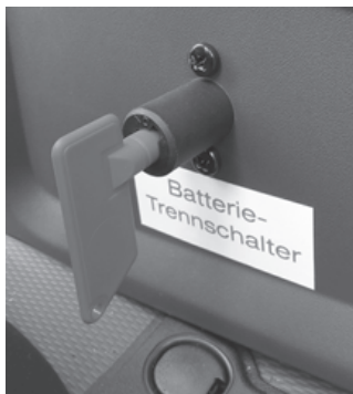
Interrupteur principal de batterie Vantana
