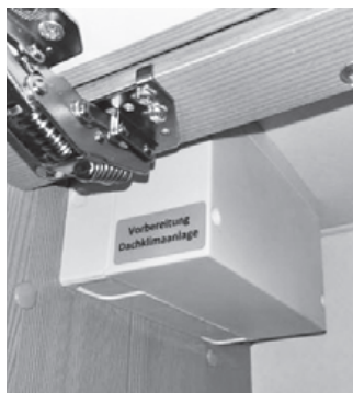
Répartiteur de toit
