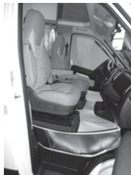
Isolation de l'espace pour les pieds dans la cabine de conduite
