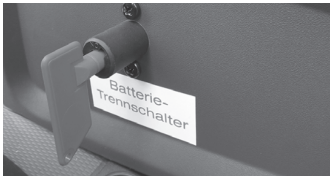
Interrupteur principal de batterie
