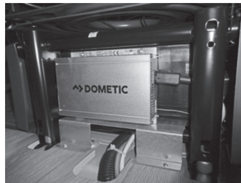
Électricité du véhicule sous le siège passager
