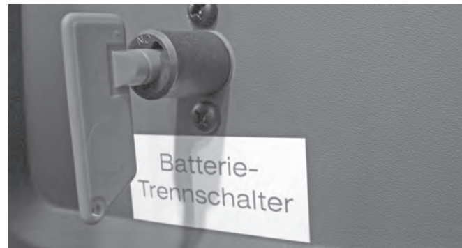
Interrupteur principal de batterie
