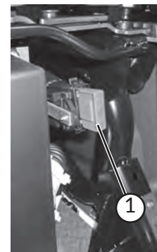
Fusible principal batterie de cellule
