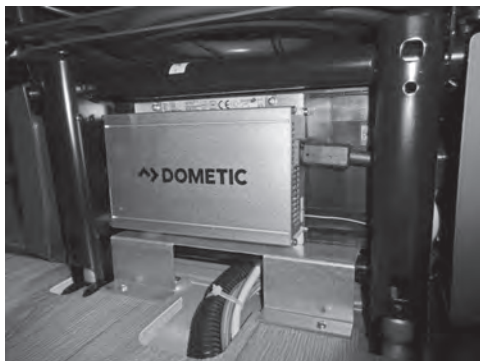
Électrique du véhicule sous le siège passager
