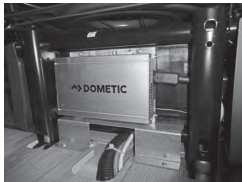
Électricité du véhicule sous le siège passager
