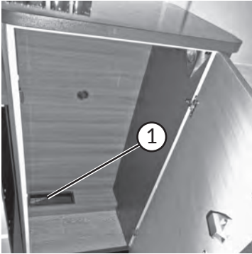
Grille d'aération réfrigérateur plancher
