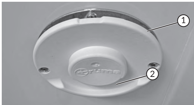
Cheminée de chauffage
