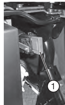
Fusible principal batterie de cellule
