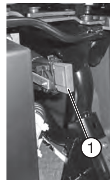
Fusible principal batterie de cellule
