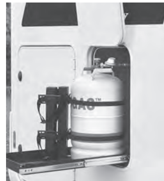
Rangement tiroir de bouteilles de gaz avec bouteille
