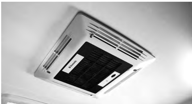
Climatiseur de toit
