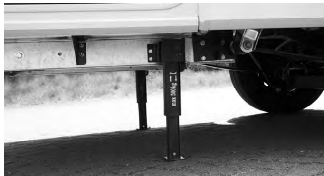
Vérins stabilisateurs déployés
