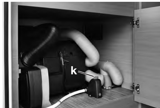
Soupape de sécurité pour chauffe-eau (FrostControl)
