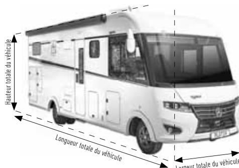
La **longueur totale du véhicule** correspond à la longueur entre le point le plus extérieur de la jupe avant et le point le plus extérieur de l'arrière (sans attelage de remorque).
