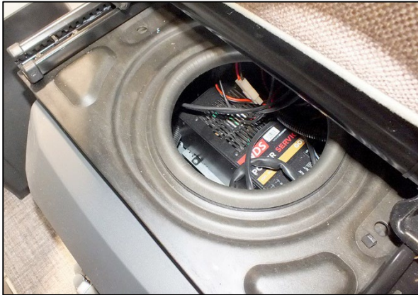
Batterieladegerät unter dem Fahrersitz (Abb. beispielhaft)
