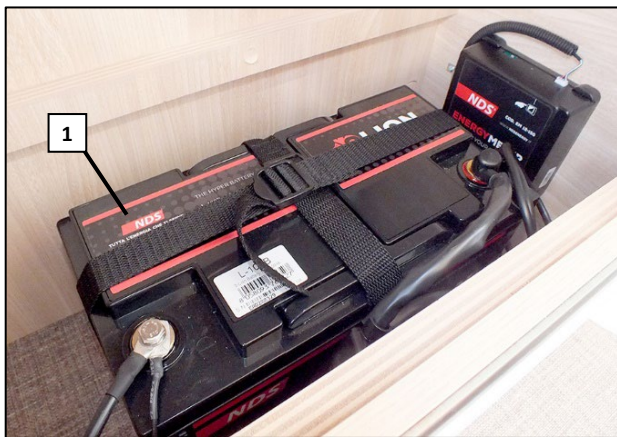
Optionale Lithiumbatterie mit Lademessgerät (Abb. beispielhaft)
