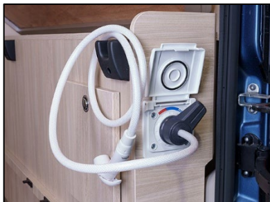
Raccord de douche supplémentaire sur le V 635 EB
