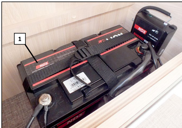
Batterie au lithium en option avec moniteur de batterie (exemple)
