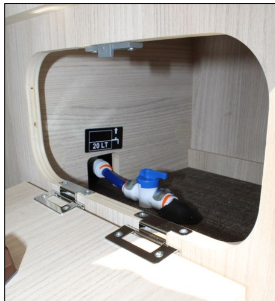
Ablassventil Frishwasserreduktion auf 20 L beim V 635 EB/HB (Abb. beispielhaft)
