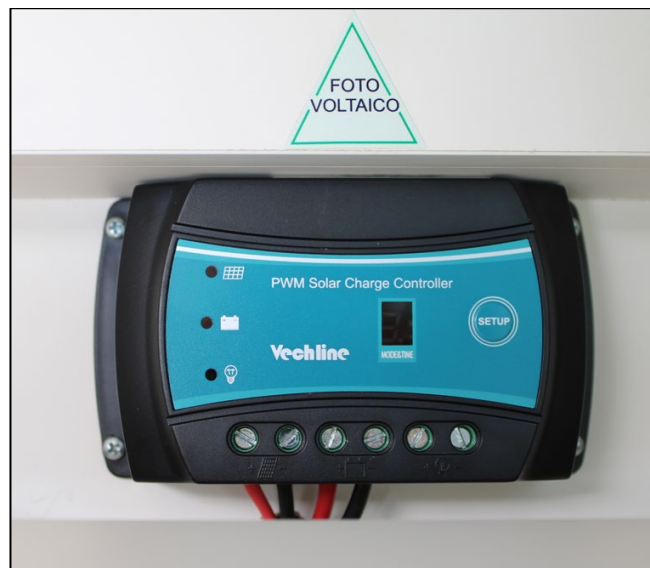
Contrôleur de charge solaire de l'installation photovoltaïque en option (exemple)
