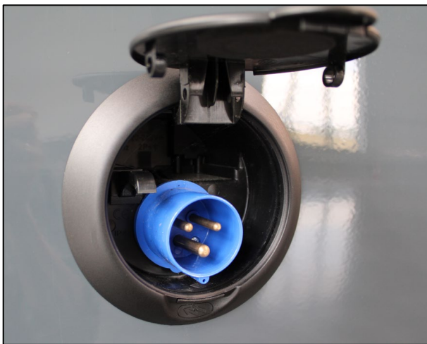
Adaptateur mâle CEE 230 V à l'extérieur du véhicule (exemple)
