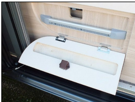
Rail de fixation à l'extérieur du bloc cuisine
