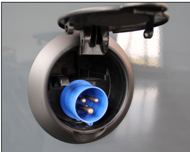
230 V-CEE Einspeise-Stecker Fahrzeugaußenseite (Abb. beispielhaft)
