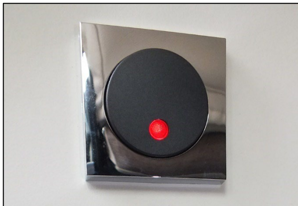
Interrupteur chauffage du réservoir d'eaux usées sur le caisson de la banquette
