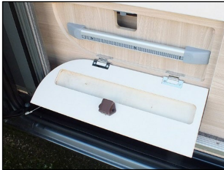
Einhängeschiene am Küchenblock außen
