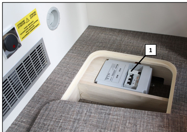
230 V-Absicherung mit FI-Schutzschalter im Wohnraumboden (Abb. beispielhaft)
