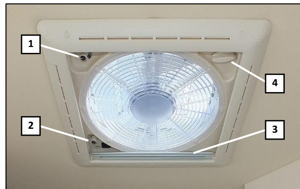
Dachlüfter mit Verdunkelungsrollo
