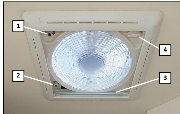
Ventilateur de toit avec store occultant
