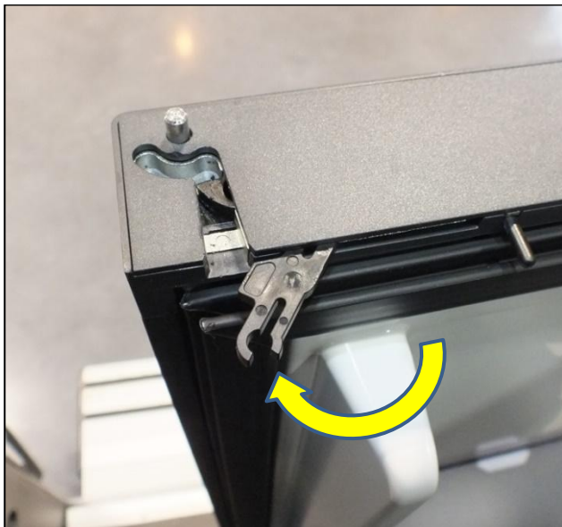
Lüftungsstellung: Sperr-Element ist herausgeschwenkt (Abb. beispielhaft)
