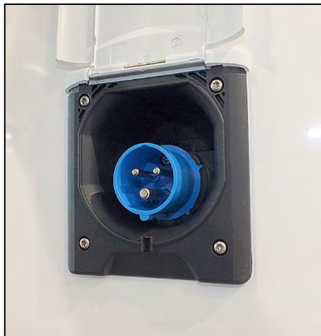
Adaptateur mâle CEE (230 V) à l'extérieur du véhicule (exemple)
