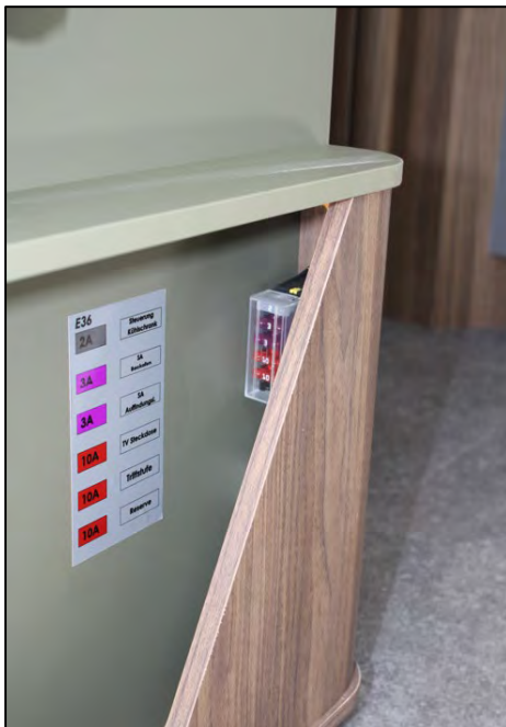
Zusatz-Sicherungshalter im Eingangsbereich (Abb. beispielhaft)
