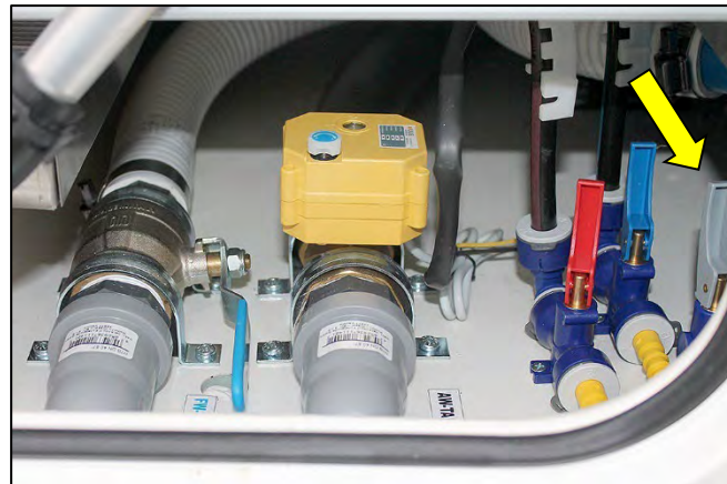
Soupape de vidange pour la réduction du volume d'eau propre à 10 L (exemple)
