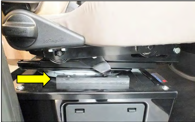
Höhenbegrenzung am Unterbau des Beifahrersitzes (Abb. beispielhaft)
