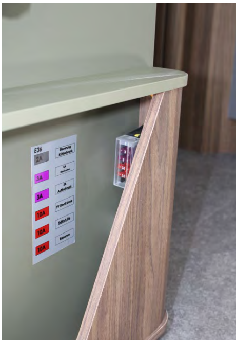
Porte-fusible supplémentaire dans la zone d'entrée (exemple)
