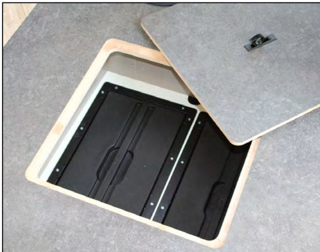
Batterie cellule dans le faux plancher (exemple).
