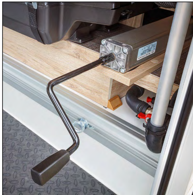
Manuelle Höhenverstellung des Zentralbetts (Abb. beispielhaft)
