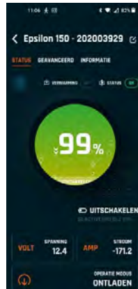
Anzeige des Ladezustands der Lithium-Batterie auf dem Smartphone (Abb. beispielhaft)
