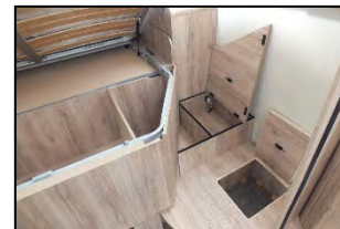
Stauraum in den Trittstufen
