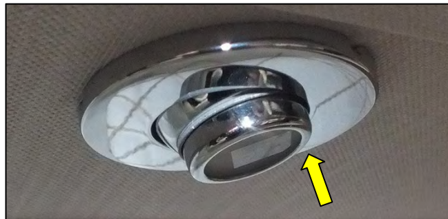
Lampe de lecture à LED encastrée
