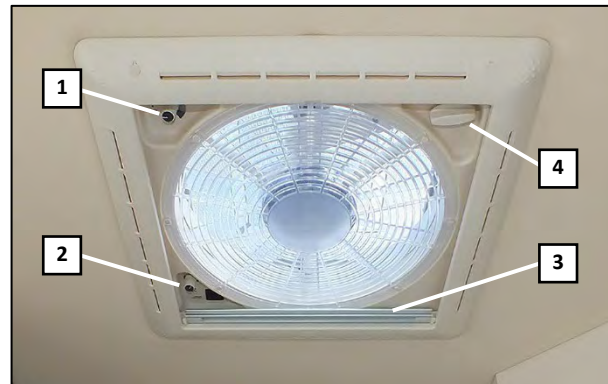
Dachlüfter mit Verdunkelungsrollo
