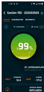
Affichage de l'état de charge de la batterie au lithium sur le smartphone (exemple)
