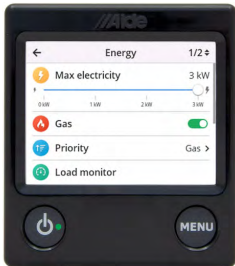
Écran de sélection de la source d'énergie (exemple)
