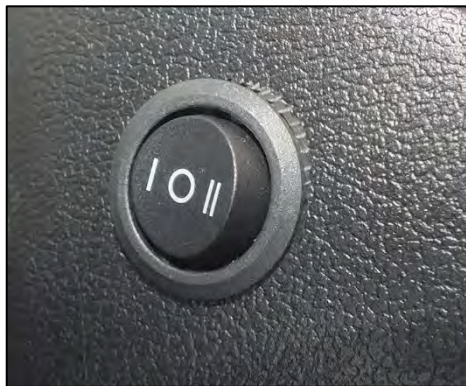
3-Positionen-Schalter für das Multimedia-System (Abb. beispielhaft)
