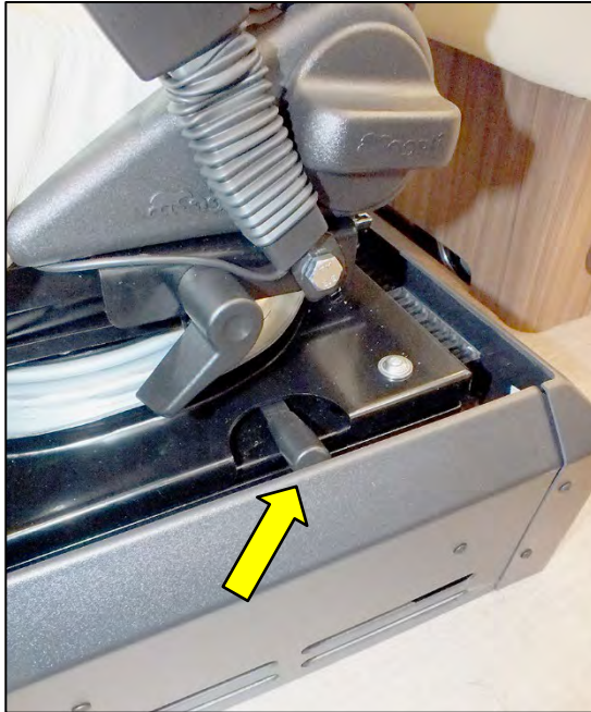
Arretierhebel am Unterbau des Fahrersitzes (Abb. beispielhaft)
