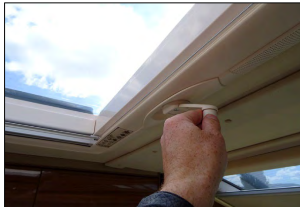
Hebekippdach öffnen/schließen (Abb. beispielhaft)
