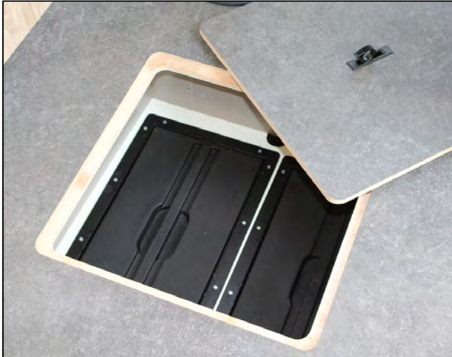
Aufbaubatterie im Doppelboden (Abb. beispielhaft).
