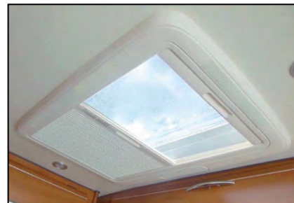
Verdunkelungsrollo an der Dachhaube (Abb. beispielhaft)
