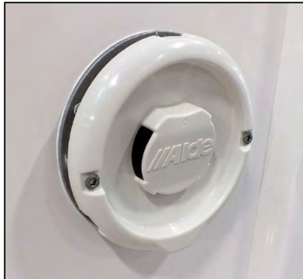
Orifice d'évacuation/d'arrivée d'air du chauffage à l'extérieur du véhicule (exemple)
