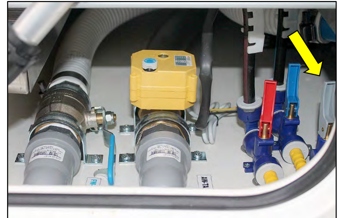
Ablassventil Frischwasserreduktion auf 10 L (Abb. beispielhaft)
