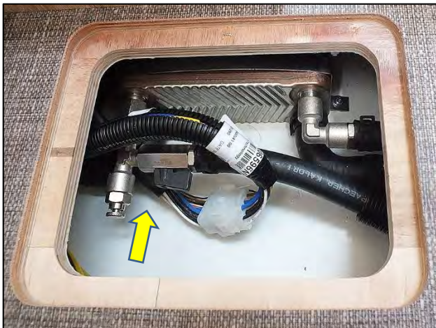
Wärmetauscher Alde (Abb. beispielhaft)
