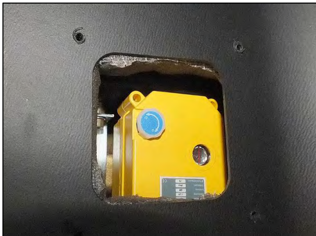
Elektrisches Ventil zur Entleerung des Abwassertanks (Abb. beispielhaft)
