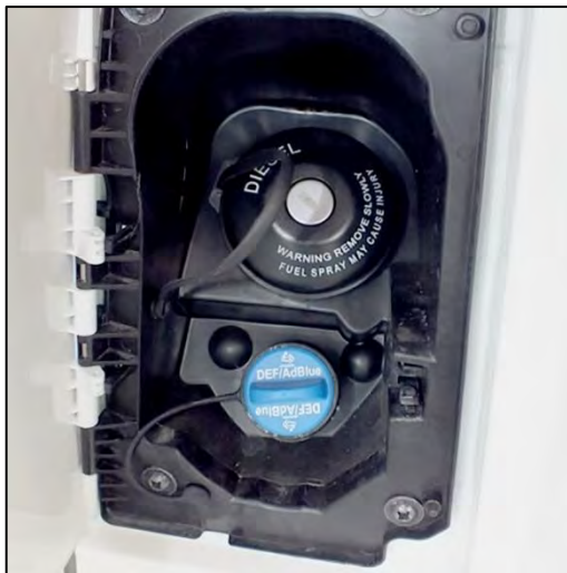
Bouchon de remplissage pour AdBlue à côté de la porte conducteur (exemple)
