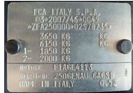
Fahrzeug-Identifikationsnummer Motorraum (Abb. beispielhaft)
