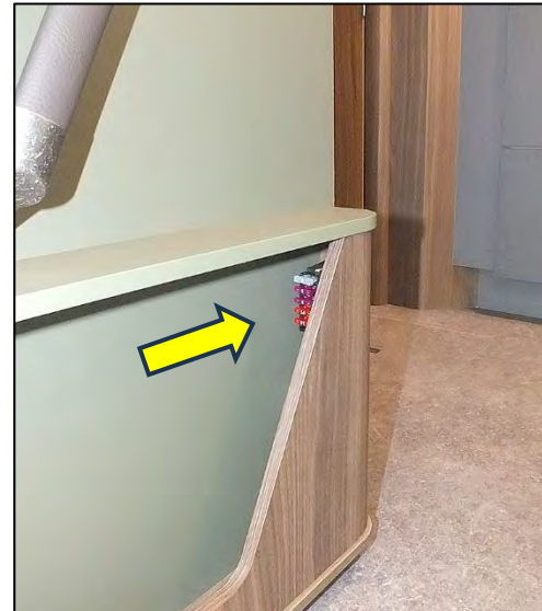
Zusatz-Sicherungshalter im Eingangsbereich (Abb. beispielhaft)
