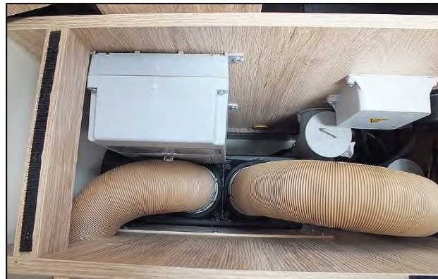
Échangeur thermique Truma dans le caisson de la banquette longitudinale (exemple)
