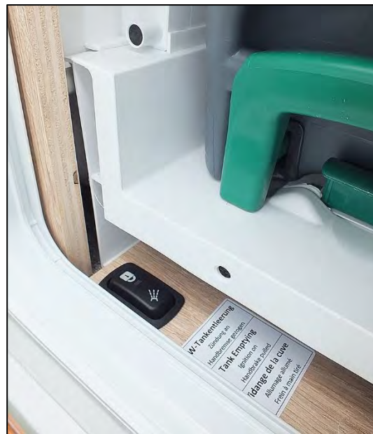
Interrupteur poussoir de vidange du réservoir d'eaux usées sur PT/PRS 675 SB (exemple)
