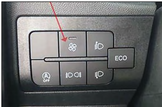
« Touche ventilateur » pour activer l'échangeur thermique (exemple)
