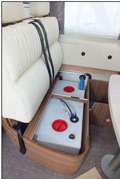
Réservoir d'eau propre dans la banquette transversale (exemple)
