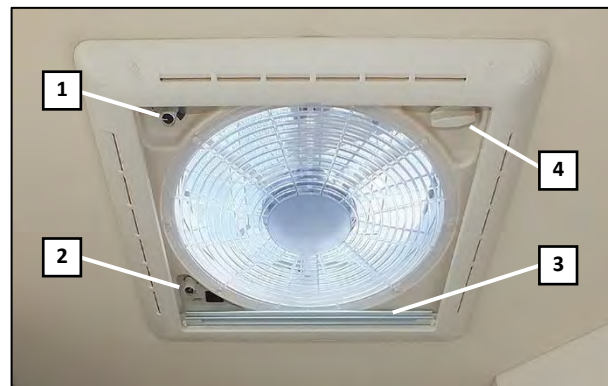
Dachlüfter mit Verdunkelungsrollo
