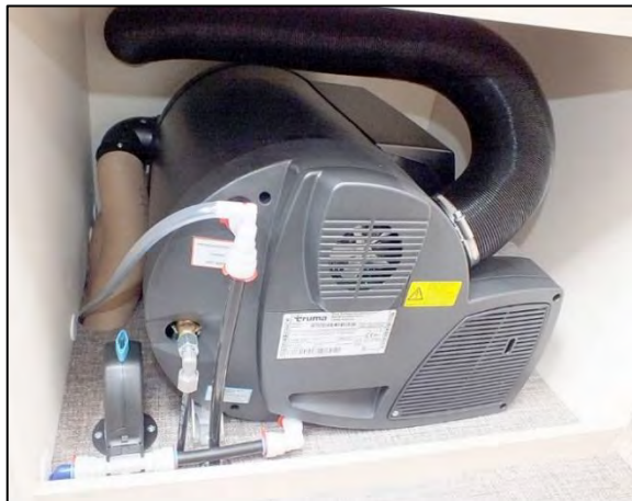
Gasbetriebene Heizung TRUMA Combi (Abb. beispielhaft)
