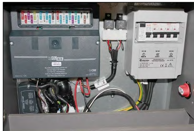
Coupe-circuit 12 V + 230 V + interrupteur coupe-batterie (exemple)
