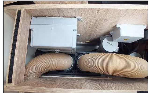
Wärmetauscher Truma im Sitzkasten der Längssitzbank (Abb. beispielhaft)
