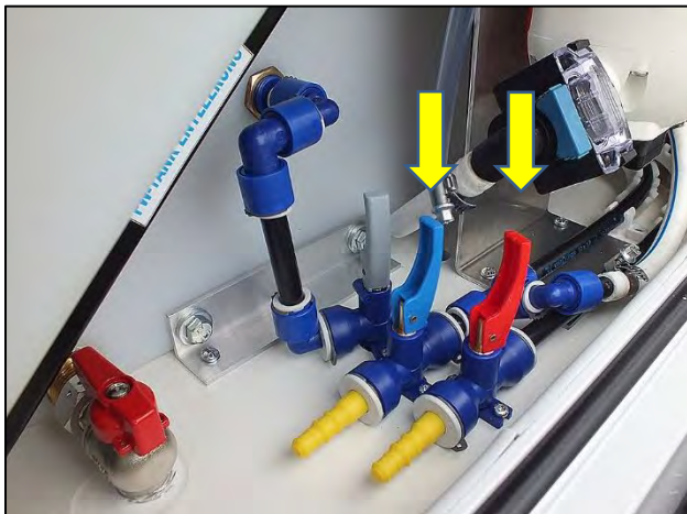
Ablassventile für Kalt- und Warmwasser (Abb. beispielhaft)
