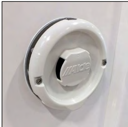
Orifice d'évacuation/d'arrivée d'air du chauffage à l'extérieur du véhicule (exemple)
