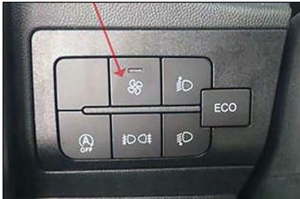
„Lüfter-Taste“ zum aktivieren des Wärmetauschers (Abb. beispielhaft)
