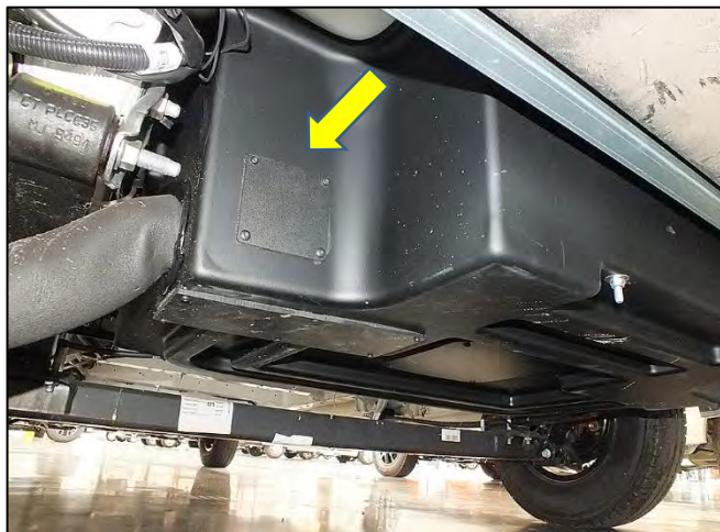
Trappe de révision à l'extérieur du réservoir d'eaux usées (exemple)
