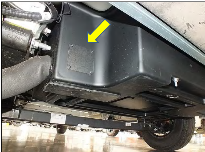
Revisionsplatte an der Außenseite des Abwassertanks (Abb. beispielhaft)
