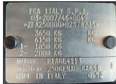
Numéro d'identification du véhicule dans le compartiment moteur (exemple)
