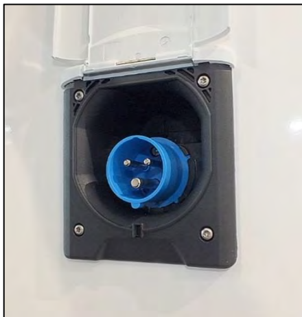
CEE-Einspeisestecker (230 V) an der Fahrzeugaußenseite (Abb. beispielhaft)
