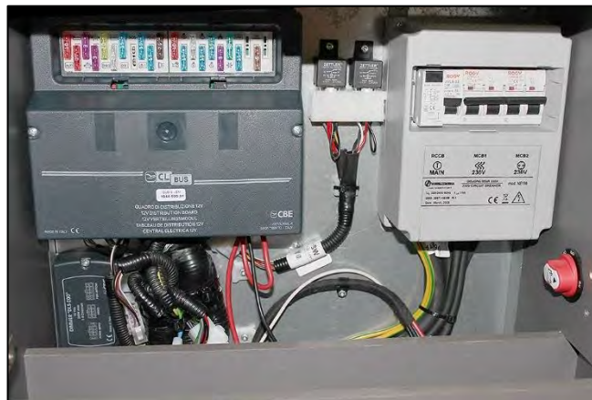
12 V + 230 V-Absicherung + Batterietrennschalter (Abb. beispielhaft)
