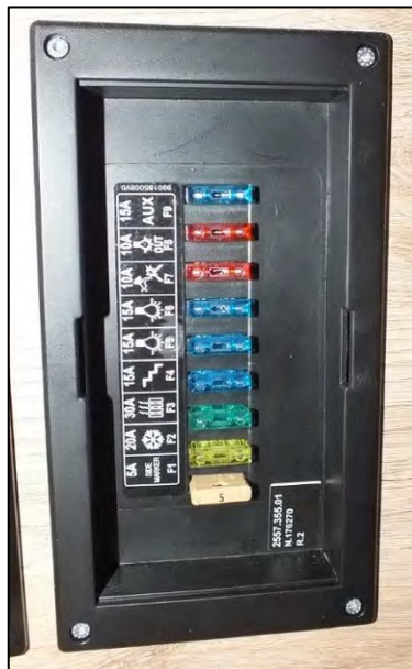
12 V-Sicherungskasten (Abb. beispielhaft)
