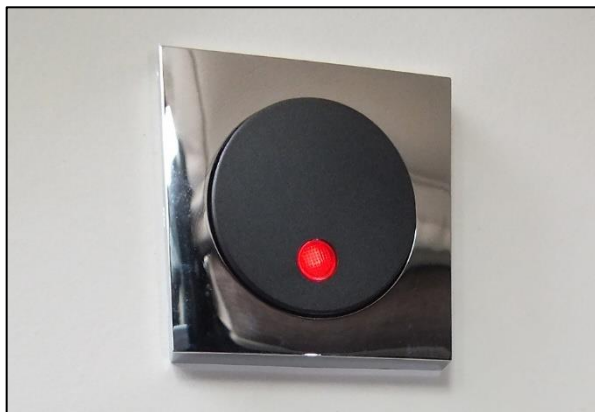
Schalter Abwassertank Beheizung am Sitzkasten
