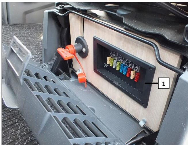
Scatola dei fusibili da 12 V e interruttore di scollegamento della batteria sotto il sedile del conducente (esempio illustrativo)
