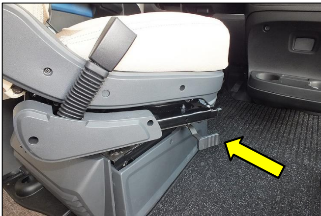
Arretierhebel am Fahrersitz (Abb. beispielhaft)
