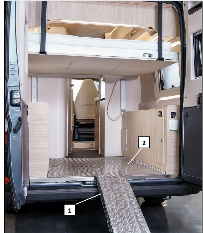
Auffahrrampe und Blechwanne beim V 635 HB (Abb. beispielhaft)
