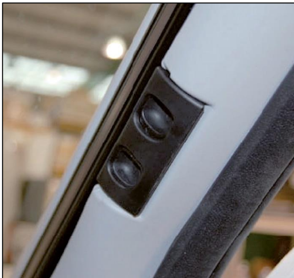
Poignées encastrées du store d'occultation du pare-brise
