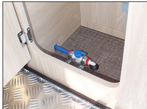
Valvola di scarico per riduzione dell'acqua dolce a 20 l nel V 635 EB/HB (esempio illustrativo)
