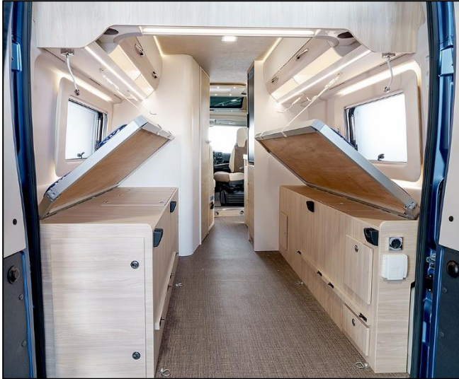
Lattenroste hochgeklappt und gesichert, zusätzliche Staumöbel und Zwischenboden entfernt (Abb. beispielhaft)
