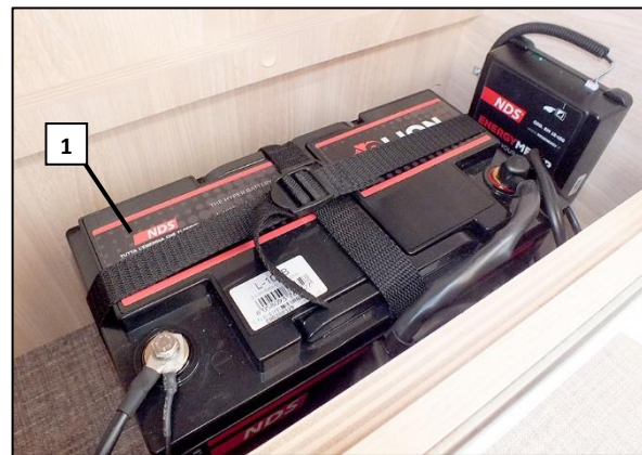
Wohnraumbatterie im Bettkasten links (Abb. beispielhaft).
