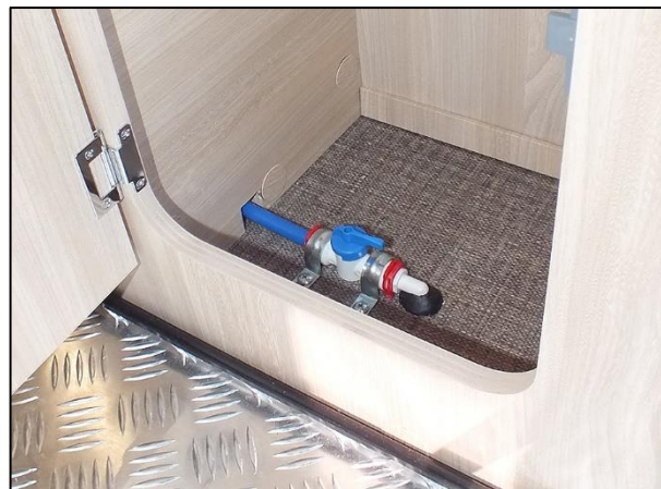
Soupape de vidange pour la réduction du volume d'eau propre à 20 L sur le V 635 EB/HB (exemple)
