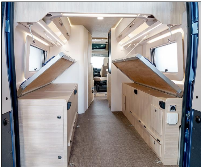
Reti a doghe ripiegate e fissate, moduli supplementari e pavimento intermedio rimossi (esempio illustrativo)
