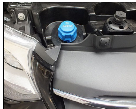
Bouchon de remplissage pour AdBlue à l'avant du compartiment moteur (exemple)
