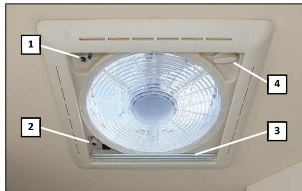
Ventilateur de toit avec store occultant
