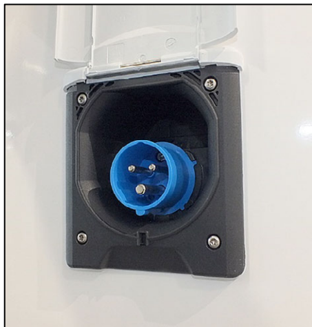
CEE Einspeise-Stecker (230 V) an der Fahrzeugaußenseite
