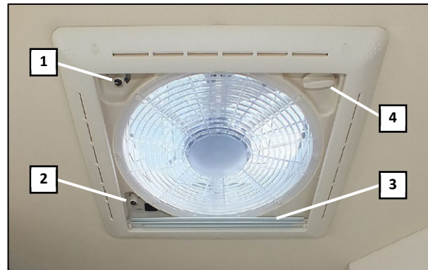
Dachlüfter mit Verdunkelungsrollo
