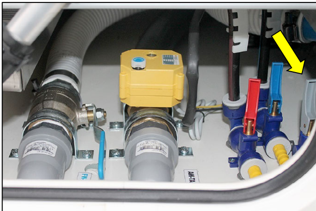
Ablassventil Frischwasserreduktion auf 25 L (Abb. beispielhaft)
