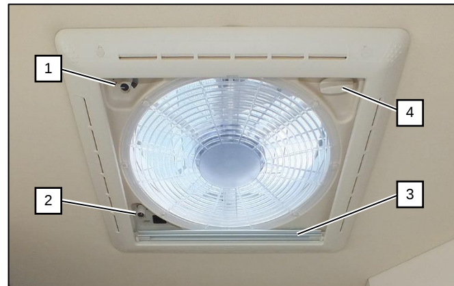
Dachlüfter mit Verdunkelungsrollo
