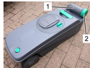
Cuve de matières fécales
