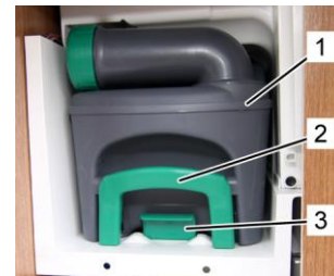
Serbatoio delle acque nere
