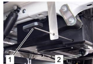
Réservoir d'eaux usées
