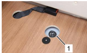
Robinet de vidange du réservoir d'eau douce
