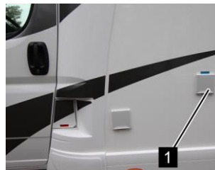
Tubulure de remplissage d'eau douce
