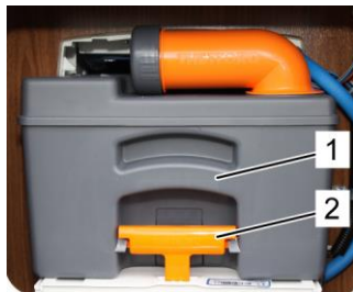
Serbatoio delle acque nere
