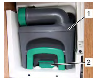
Cuve de matières fécales
