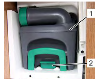
Serbatoio delle acque nere
