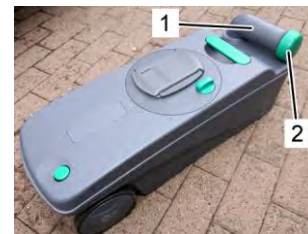
Cuve de matières fécales
