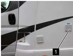
Tubulure de remplissage d'eau douce
