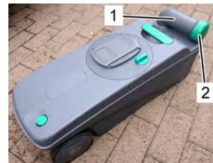
Serbatoio delle acque nere
