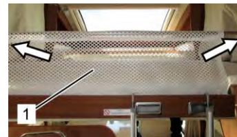
Rete di sicurezza protettiva anticaduta
