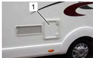
Couvercle de la cuve de matières fécales
