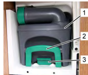
Serbatoio delle acque nere
