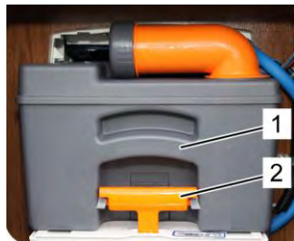
Cuve de matières fécales
