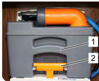
Serbatoio delle acque nere
