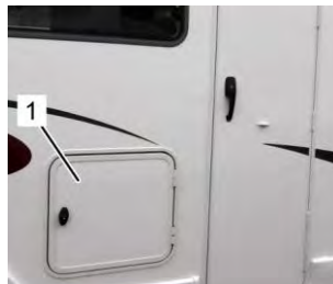
Porte du casier des bouteilles de gaz
