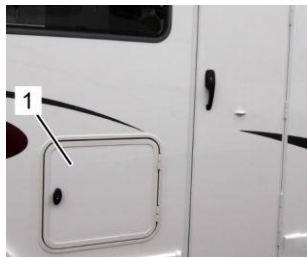
Porte du casier des bouteilles de gaz
