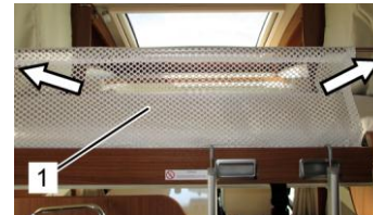
Rete di sicurezza protettiva anticaduta
