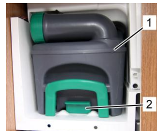
Cuve de matières fécales
