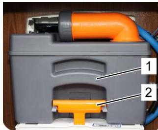
Cuve de matières fécales
