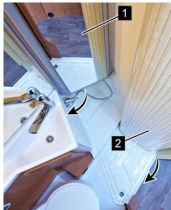
Trasformazione in cabina doccia
