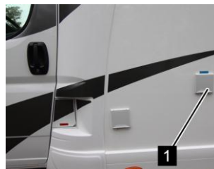
Tubulure de remplissage d'eau douce
