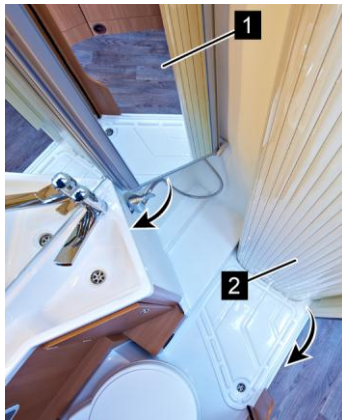
Transformation en cabine de douche
