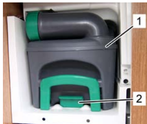
Serbatoio delle acque nere
