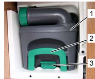
Serbatoio delle acque nere
