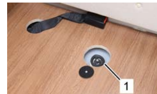
Robinet de vidange du réservoir d'eau douce
