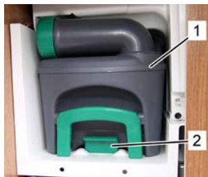
Cuve de matières fécales
