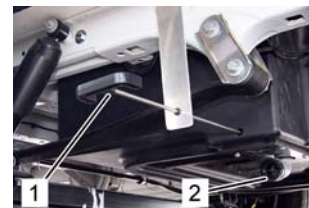
Réservoir d'eaux usées
