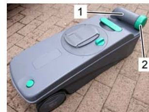
Serbatoio delle acque nere
