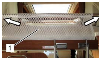
Rete di sicurezza protettiva anticaduta
