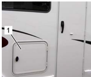
Porte du casier des bouteilles de gaz
