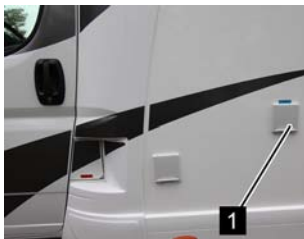
Tubulure de remplissage d'eau douce
