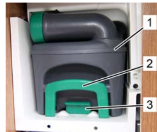
Cuve de matières fécales
