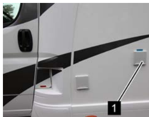
Bocchettone di riempimento serbatoio dell'acqua sanitaria
