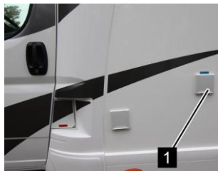
Raccord d'alimentation du réservoir d'eau
