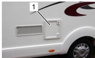
Couvercle de la cuve de matières fécales
