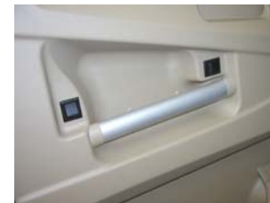
Bloccaggio della porta della cabina di guida
