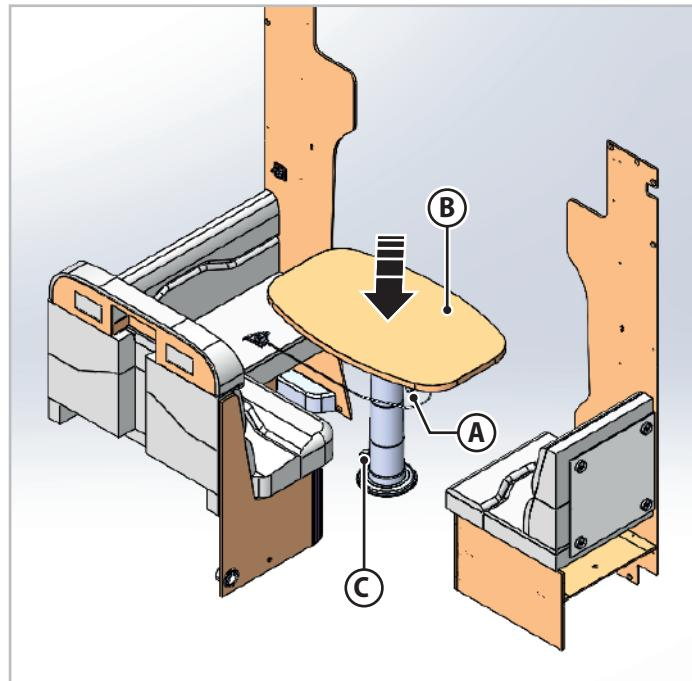
2. Utiliser le levier A pour amener le plateau de la table B en position centrale, entre le canapé et le fauteuil. Appuyer sur le bouton C et abaisser le plateau de la table B.
