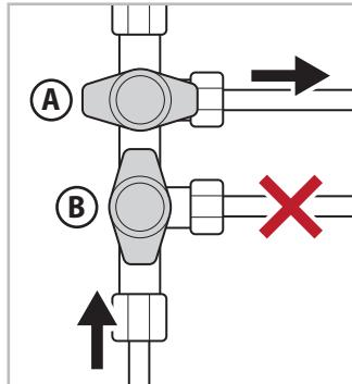
Fig. 6.29 - Ouverture et fermeture des robinets
