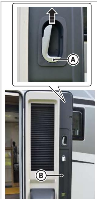
Fig.5.2 - Ouverture/Fermeture de la porte d'entrée de l'intérieur
