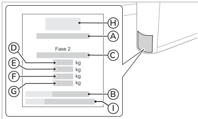
Fig. 1.1 - Plaque d'identification de la caisse
