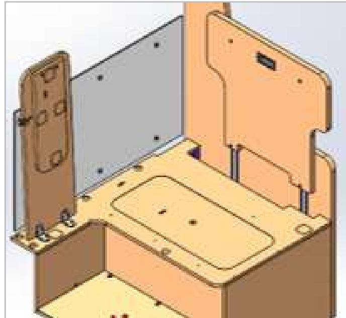
3. Relever le dossier coulissant : tirer le loquet situé sur le côté entrée pour débloquer le coulisement. En fin de course, le loquet se réinsère à l'intérieur du meuble.
