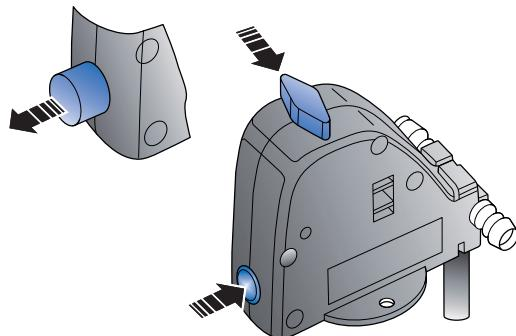
Fig. 6.47 - Soupape de sécurité Combi
