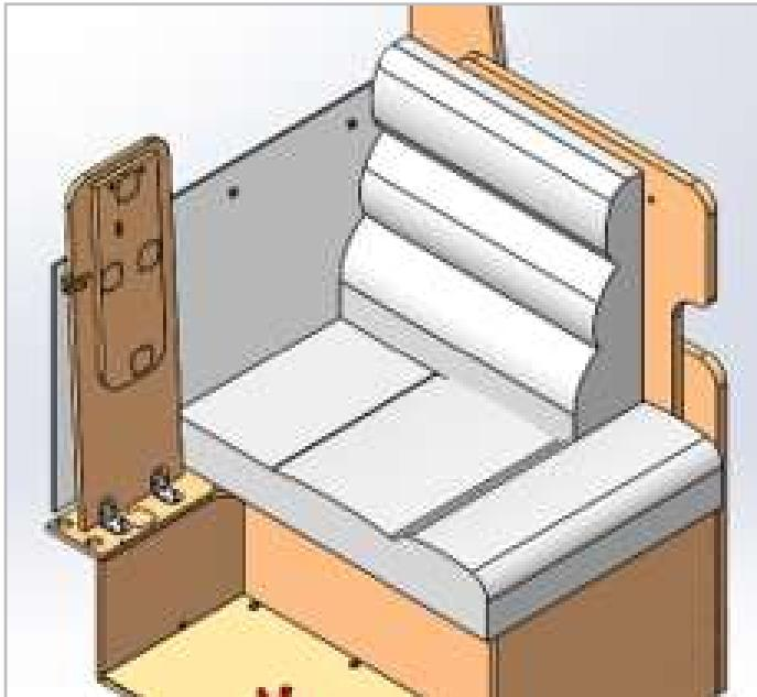
4. Remettre en place les coussins. Repositionner l'assise arrière dans sa position initiale et pivoter le dossier de 90°, en l'appuyant contre le côté coulissant.
