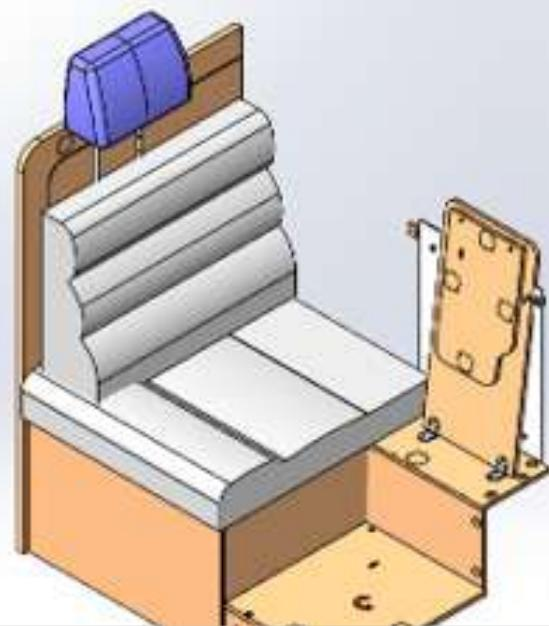
5. Remettre en place les coussins. Poser l'assise arrière dans sa position initiale et pivoter le dossier de 90°, en l'appuyant contre le côté pivotant. En cas d'utilisation du système Isofix, placer le rehausseur dédié entre le coussin et le plan du coffre.
