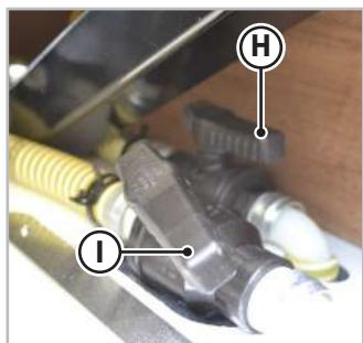
Fig. 6.39 - Vanne de vidange d'eau propre double plancher
