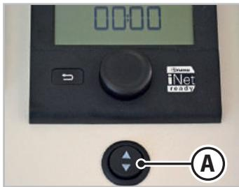
Fig.6.19 - Commande du lit pavillon au-dessus de la dînette
