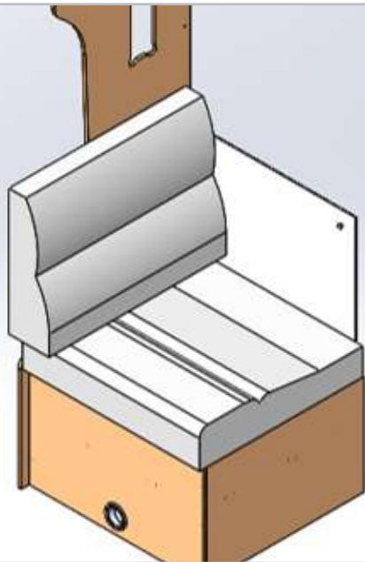
3. Remettre en place le coussin en le tournant de 90°, vers le côté avant.
