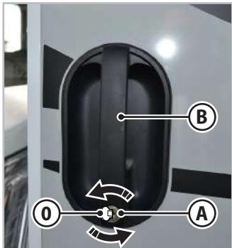
Fig.5.1 - Ouverture/Fermeture de la porte d'entrée de l'extérieur
