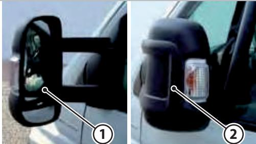
Fig. 4.1 - Fermeture du rétroviseur
