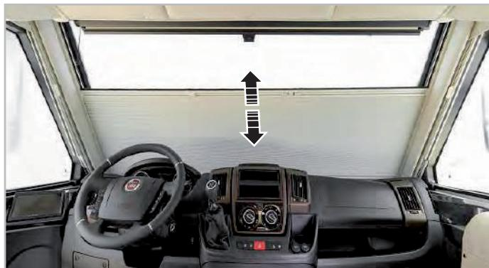
Fig. 6.16 - Store occultant pliable pour pare-brise
