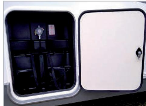
Fig. 6.30 - Compartiment à bouteilles de gaz
