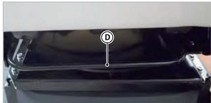
Fig. 3.7 - Levier de coulissemement du siège
