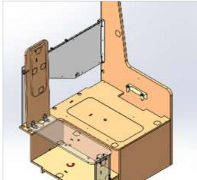
7. Relever la rallonge avant, en la repliant et la posant sur le côté. Bloquer cette dernière à l'aide de l'arrêteoir pivotant situé sur le côté avant.
