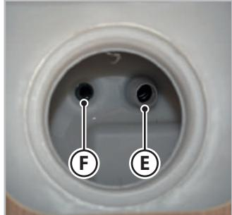
Fig. 6.38 - Vanne de vidange d'eau propre
