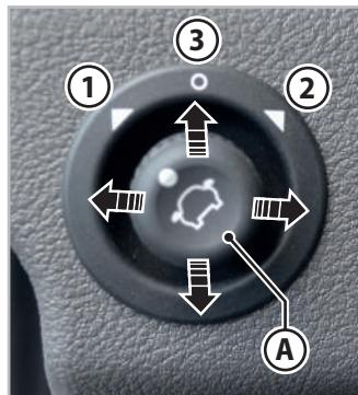
Fig. 3.1 - Réglage des rétroviseurs
