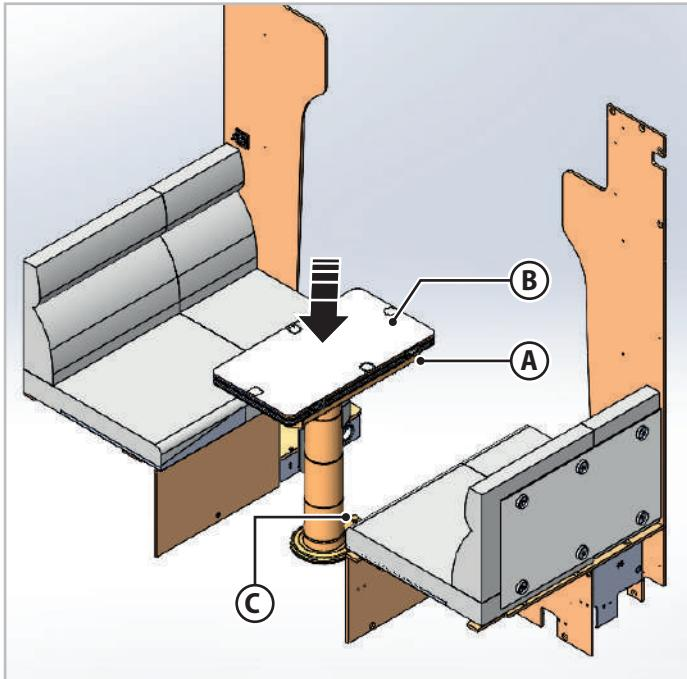
2. Utiliser le levier **A** pour amener le plateau de la table **B** en position centrale. Appuyer sur le bouton **C** et abaisser le plateau de la table **B**.
