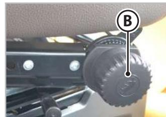
Fig. 3.5 - Commande de réglage du coussin
