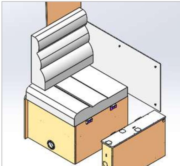
4. Remettre en place le coussin de l'assise en le tournant de 90°, vers le côté avant.
