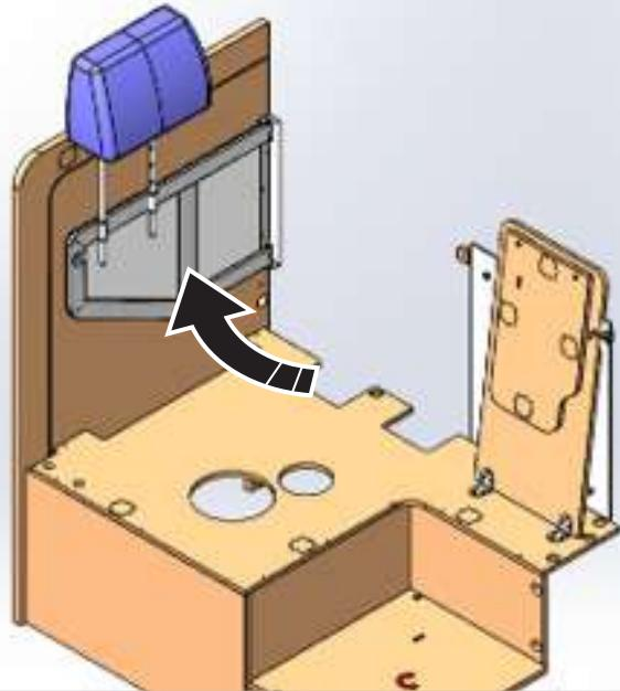
4. Ouvrir le panneau pivotant mural en le tournant jusqu'à ce qu'il touche l'aimant situé sur le côté cuisine. Insérer l'appuie-tête dans son logement.
