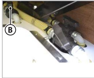
Fig. 6.42 - Vanne de vidange eaux grises double plancher
