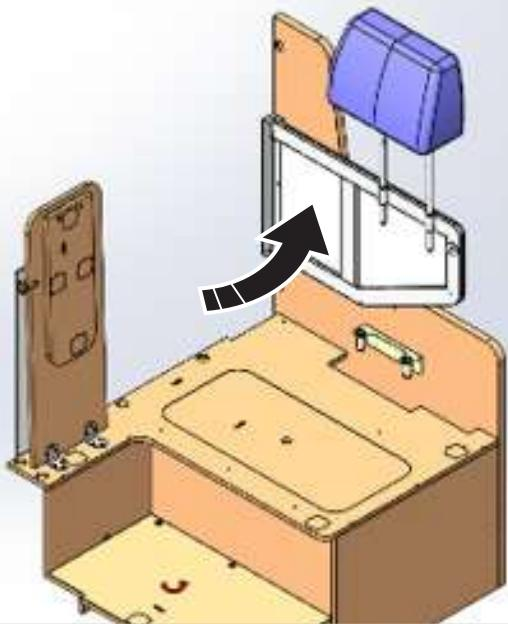
8. Ouvrir le panneau mural pivotant en le tournant jusqu'à ce qu'il touche l'aimant situé sur le côté entrée. Insérer l'appuie-tête dans son logement.
