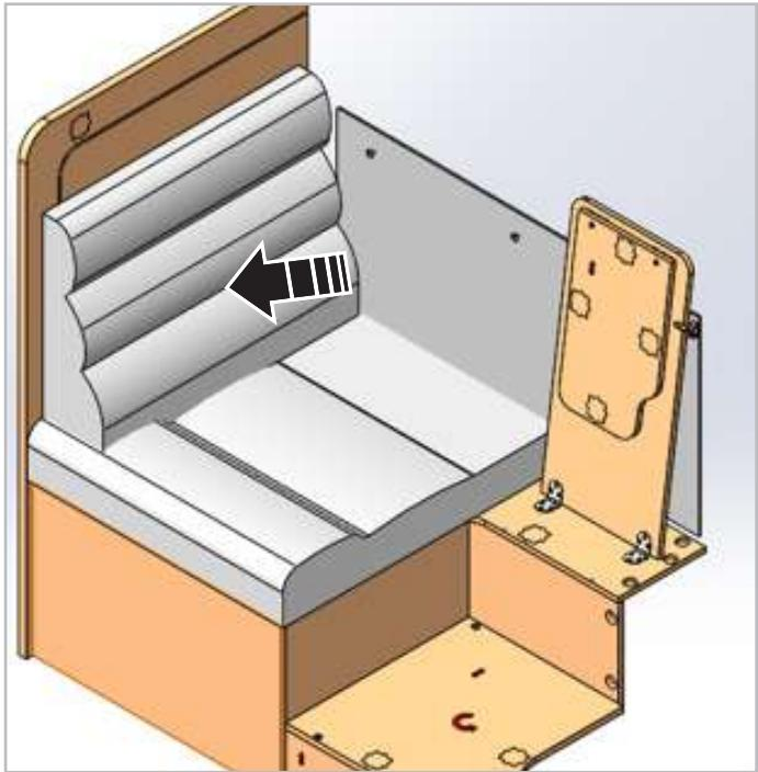
4. Tourner le dossier de 90° et le placer à côté de la cuisine. En cas d'utilisation du système Isofix, placer le rehausseur dédié entre le coussin et le plan du coffre.
