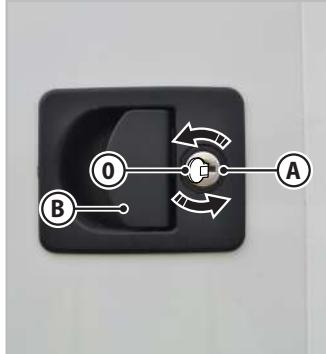
Fig. 5.4 - Ouverture/fermeture du compartiment garage
