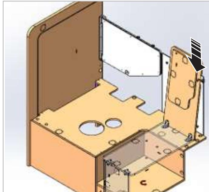
3. Relever la rallonge avant, en la repliant et la posant sur le côté. Bloquer cette dernière à l'aide de l'arrêteoir pivotant situé sur le côté avant.
