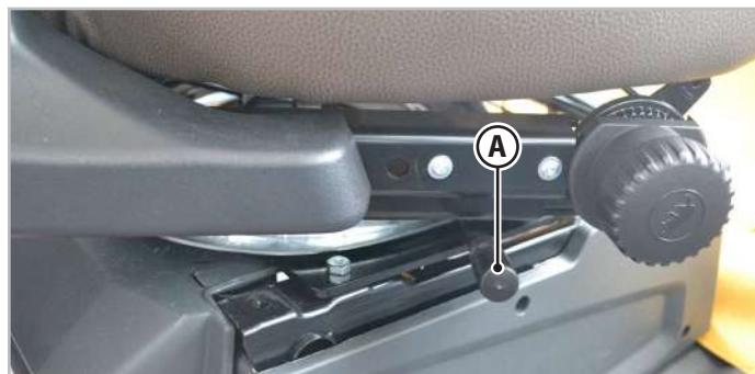
Fig.3.3 - Rotation du siège
