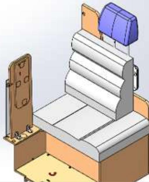
9. Remettre en place les coussins. Poser l'assise arrière dans sa position initiale et pivoter le dossier de 90°, en l'appuyant contre le côté pivotant.
