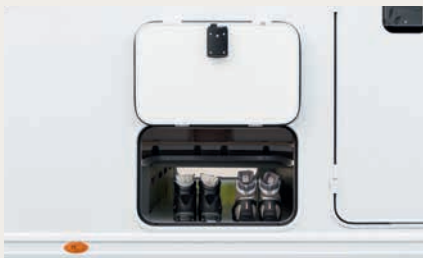
» Double plancher partiel sur toute la largeur du véhicule permettant un chargement transversal
