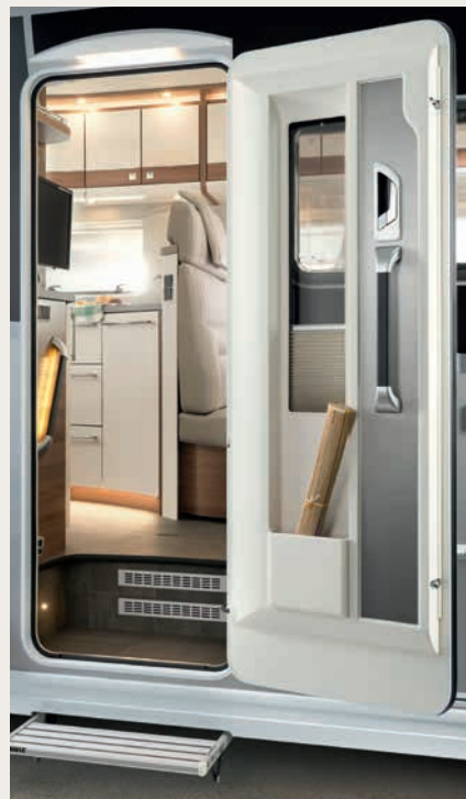
» Porte cellule extra large (70 cm) avec baie, fermeture centralisée (incluant la porte cabine), habillage intérieur, moustiquaire et assistance de fermeture électrique
