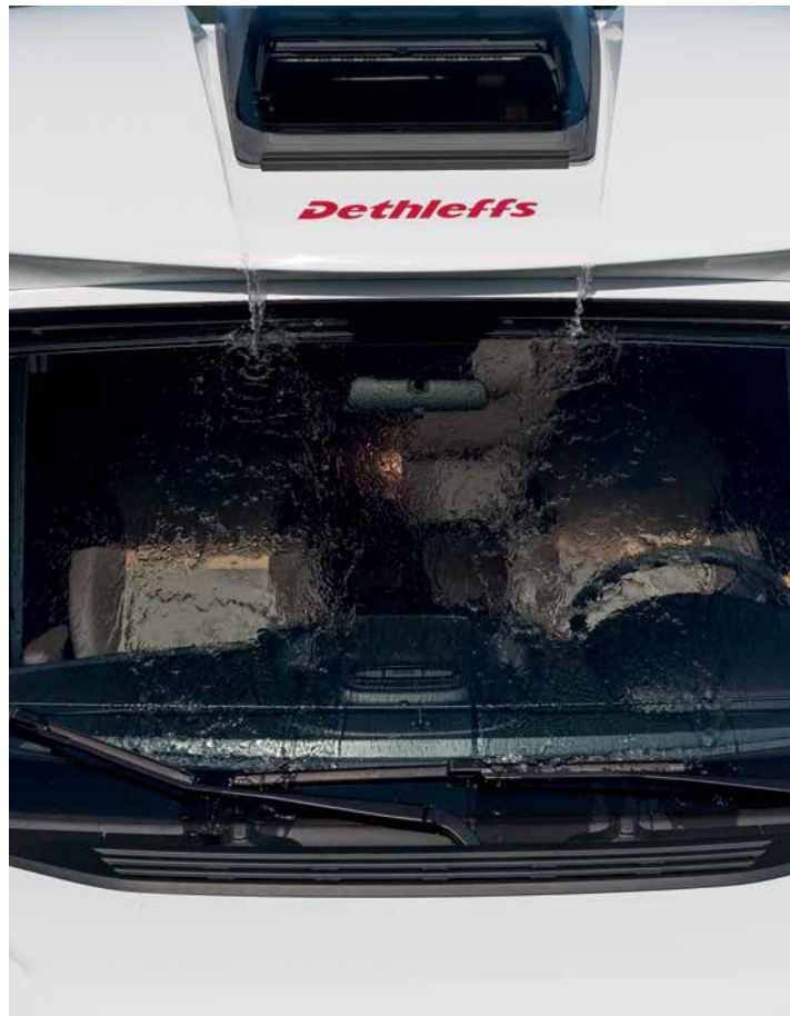
» Canalisation et dérivation de l'eau de pluie
