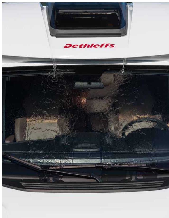
» Canalisation et dérivation de l'eau de pluie
