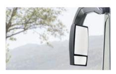
Double rétroviseur électrique et chauffant type bus pour un champ de vision optimal
