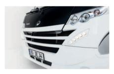
I: Feux de jour à LED intégrés dans le pare-chocs avant et grille de protection du radiateur
