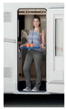
Porte cellule extra large de 70 cm avec marche-pied intégré, moustiquaire et fermeture centralisée
