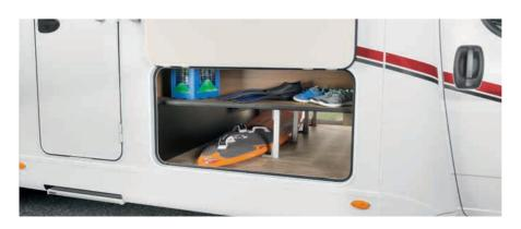
A 7877-2 Double plancher d'une belle hauteur permettant un chargement sur toute la largeur du véhicule. De plus cet espace permet de protéger les réservoirs et autres du gel
