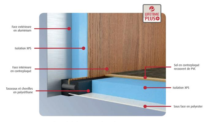
Les parois, le toit et le plancher sont exempts de ponts thermiques et entièrement conçus sans tasseaux en bois. A la place, des tasseaux en polyuréthane, améliorent la rigidité des panneaux et évitent la distorsion de la cellule.
