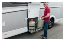
Coffre à gaz avec panier coulissant pour un remplacement aisé (selon implantation)
