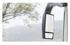
I : double rétroviseur électrique et chauffant type bus pour un champ de vision optimal
