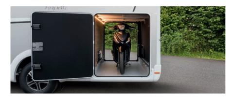
Grande soute (suivant modèle) éclairée et décaissée avec rallonges de châssis rabaissées et renforcées, permettant une charge maximale de 150 kg. Ouverture de soute aisée avec une seule main
