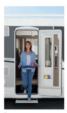
Large porte cellule de 70 cm avec baie, habillage intérieur, moustiquaire et fermeture centralisée
