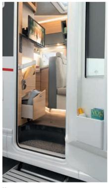
Module d'entrée multifonctionnel, qui s'étend jusqu'au milieu du véhicule, comprenant un compartiment fort pratique pour les chaussures, une solide poignée facilitant l'accès et de l'espace pour un téléviseur en option
