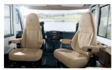
I: Sièges conducteur et passager grand confort, réglables en hauteur, avec ceintures intégrées et deux accoudoirs
