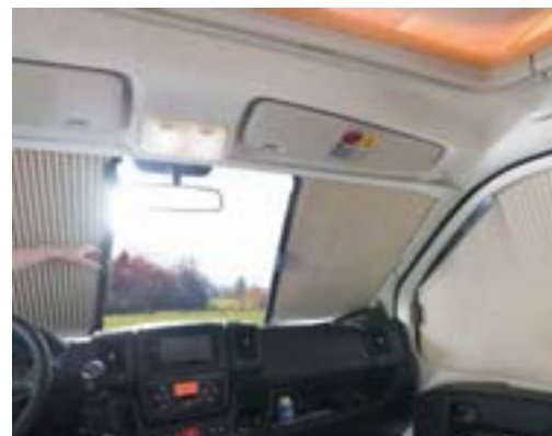
+ Obturateurs de cabine pour se préserver de la chaleur, du froid et des regards extérieurs
