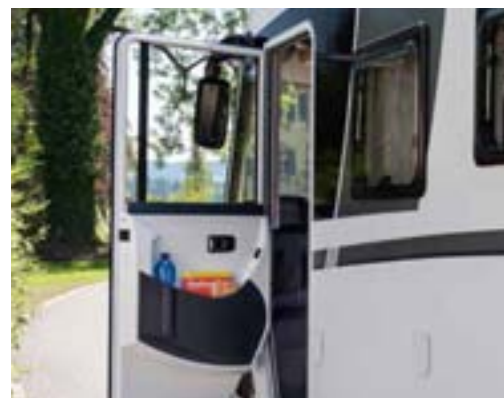
+ Porte cabine avec lève-vitre électrique et fermeture centralisée
