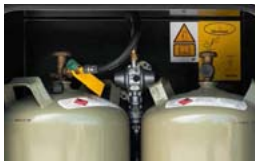
+ Système « Crashesensor » permettant l'utilisation du gaz en roulant
