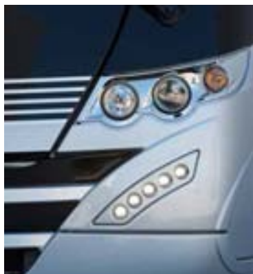
+ Face avant en GFK avec feux de jour à LED en 2 parties (2)
