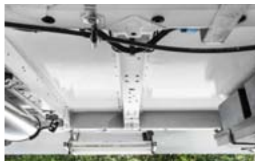
+ Technique de plancher Lifetime-Smart, sans tasseaux bois et imputrescible
