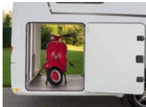
+ Soute décaissée avec rallonges de châssis rabaisées et renforcées - charge maximale 250 kg
