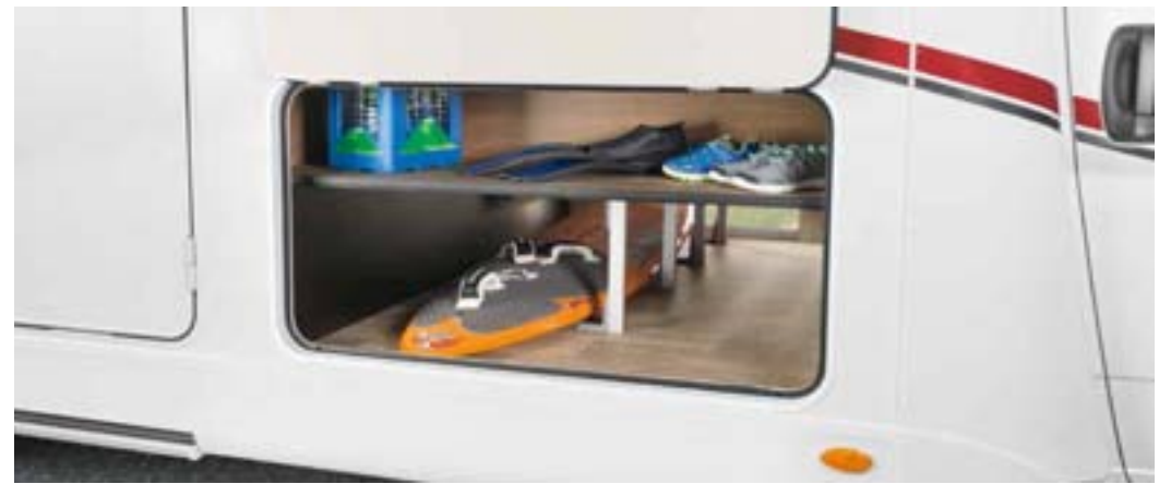
+ A 7877-2 : Double plancher d'une belle hauteur permettant un chargement sur toute la largeur du véhicule. De plus cet espace permet de protéger les réservoirs et autres du gel
