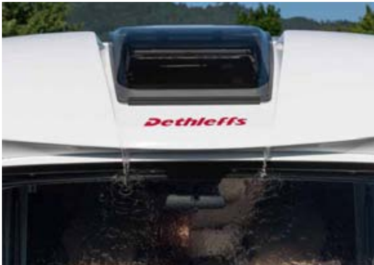
+ Canalisation et dérivation de l'eau de pluie
