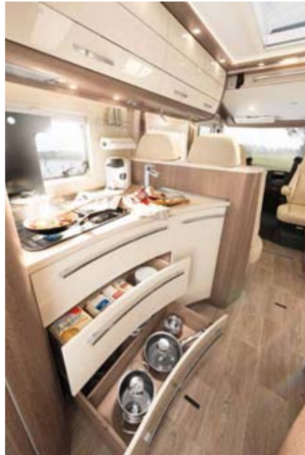
+ Les grands tiroirs coulissants se verrouillent automatiquement au démarrage
