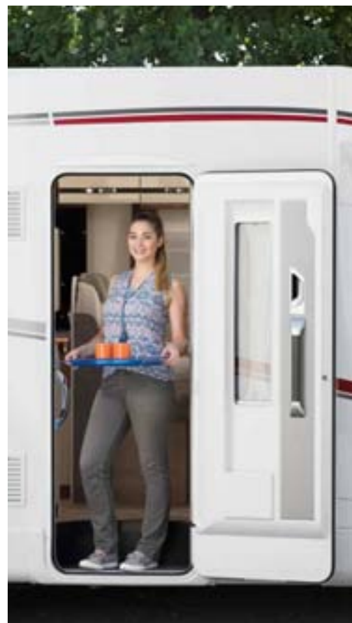
+ Porte cellule extra large de 70 cm avec marche-pied intégré, moustiquaire et fermeture centralisée
